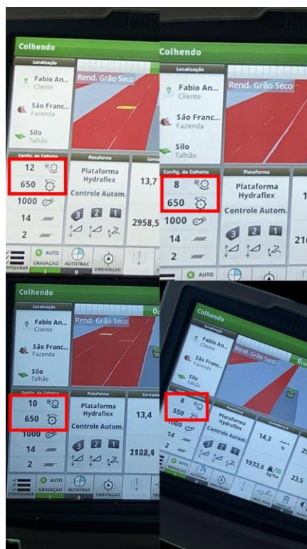
Figura 3 – Nesta imagem em destaque estão a combinação de abertura de côncavo e rotação do rotor.
