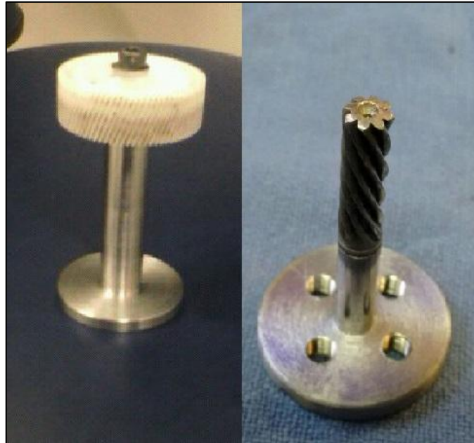
Figura 3.10 - Transmissão de engrenagens com redução.
