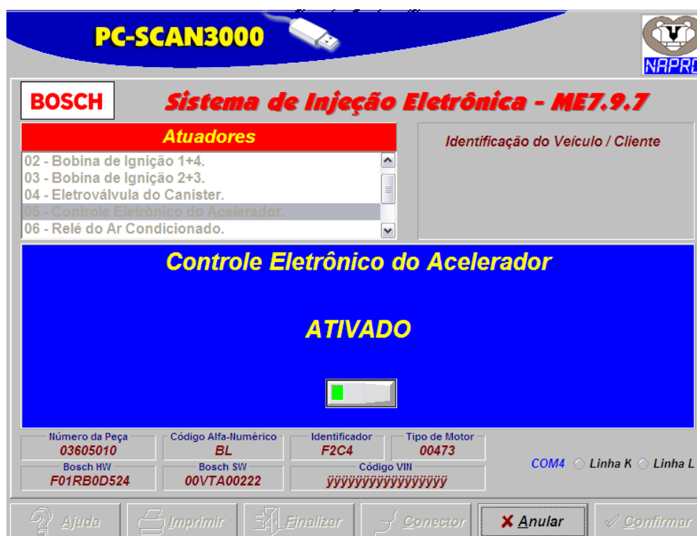
Figura 13: Ativar comando para teste com atuadores do motor. (Extraído de Scanner PC SCAN 3000 USB – Napro Eletrônica).
