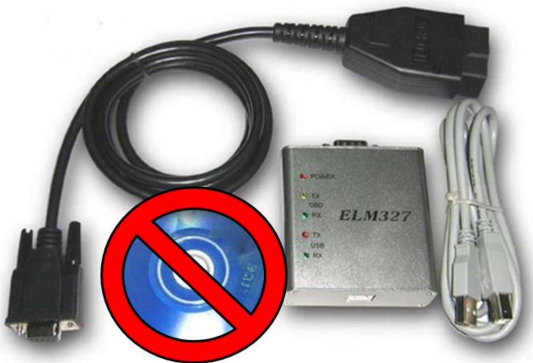
Figura 27: Imagem do Scanner ELM 327 V1.5ª, utilizado neste projeto.(Adaptado de http://www.eobd2.com ).
