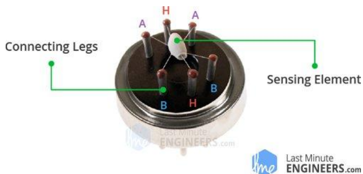
Figura 8 – Parte interna do sensor MQ-2 e seus terminais
