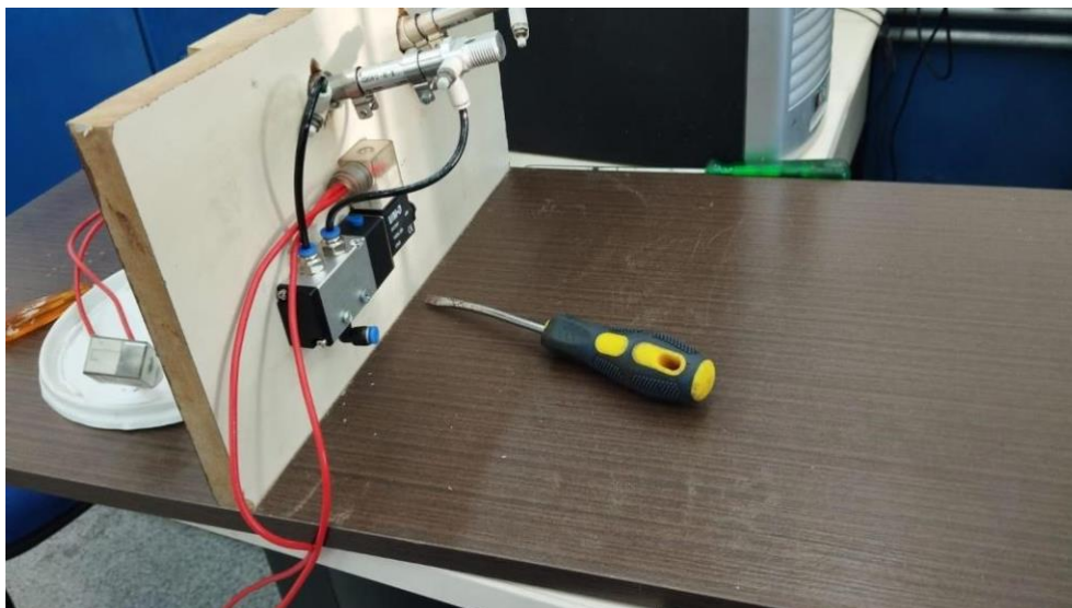
Figura 8 ° - Instalação das válvulas simples solenoide. Fonte: Próprio autor.
