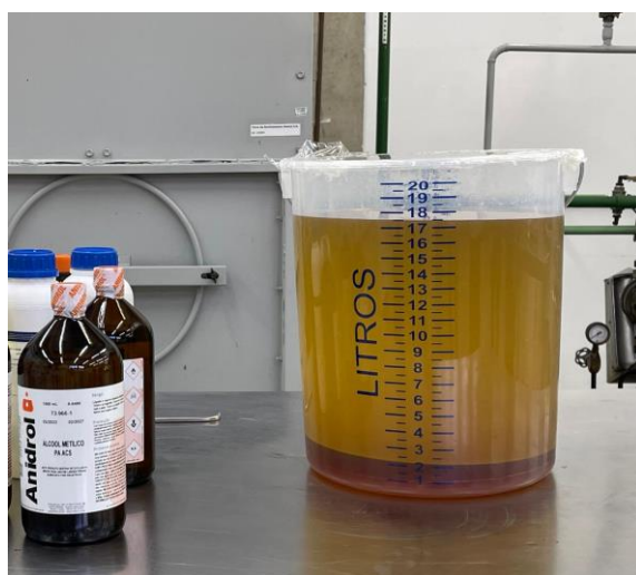
Figura 8 – Mistura após descanso, onde a parte debaixo mais escura é a glicerina e a parte superior é o biodiesel pronto para uso
