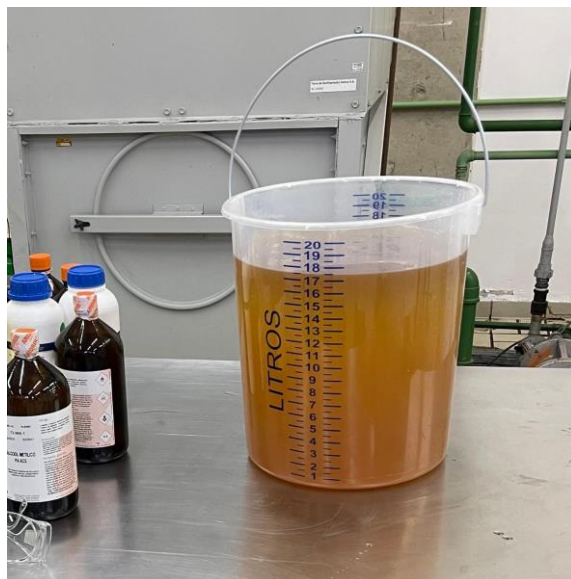
Figura 7 – Mistura após sair do reator, sem repouso
