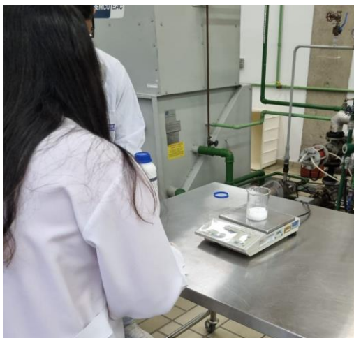
FIGURA 2. Hidróxido de sódio sendo pesado em balança
