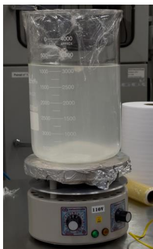
Figura 4. Peixinho agitando sob agitador magnético e misturando 2 reagentes
