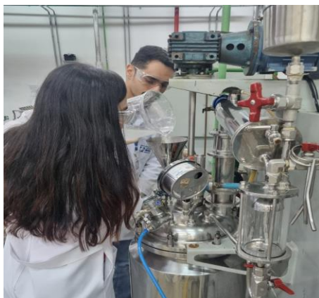
Figura 6 – Adicionando metilato de sódio no reator
