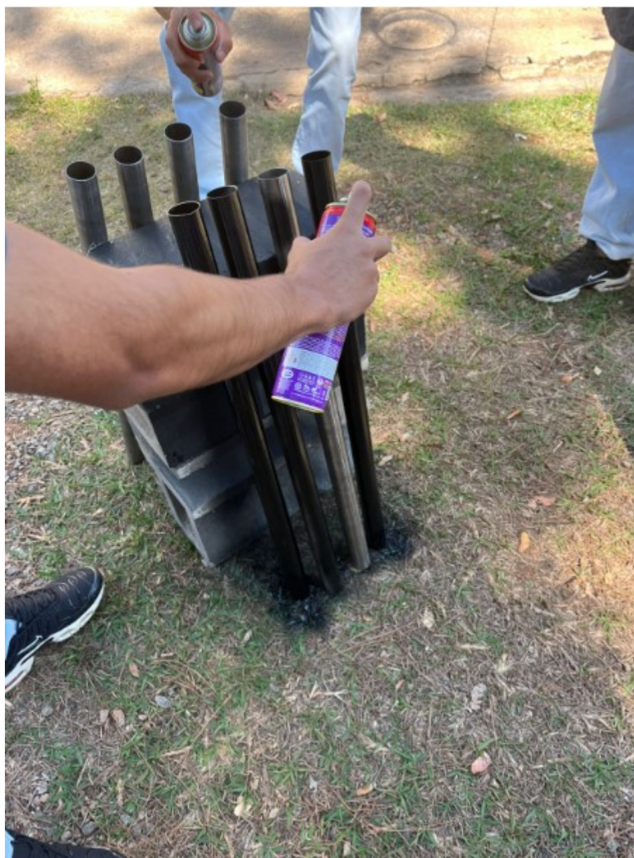
Figura 18 - Pintura dos pés após medir para o corte
