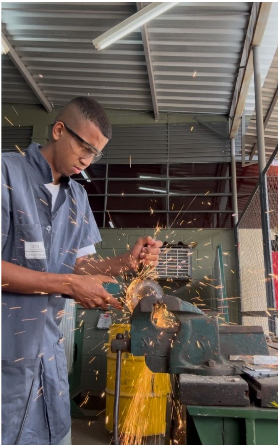
Figura 23 - Corte dos parafusos com a esmerilhadeira
