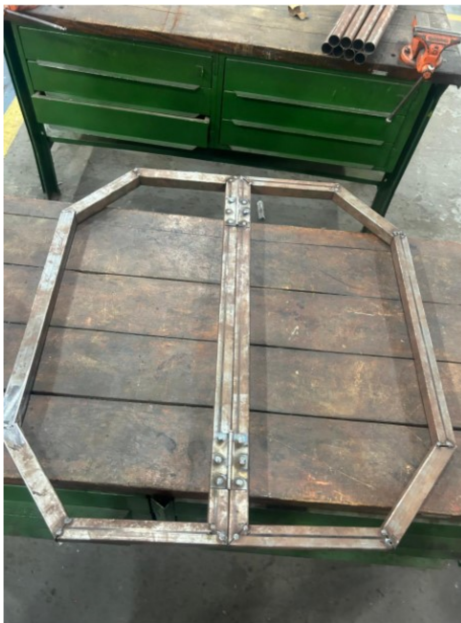
Figura 15 - Após a soldagem das dobradiças a base pronta
