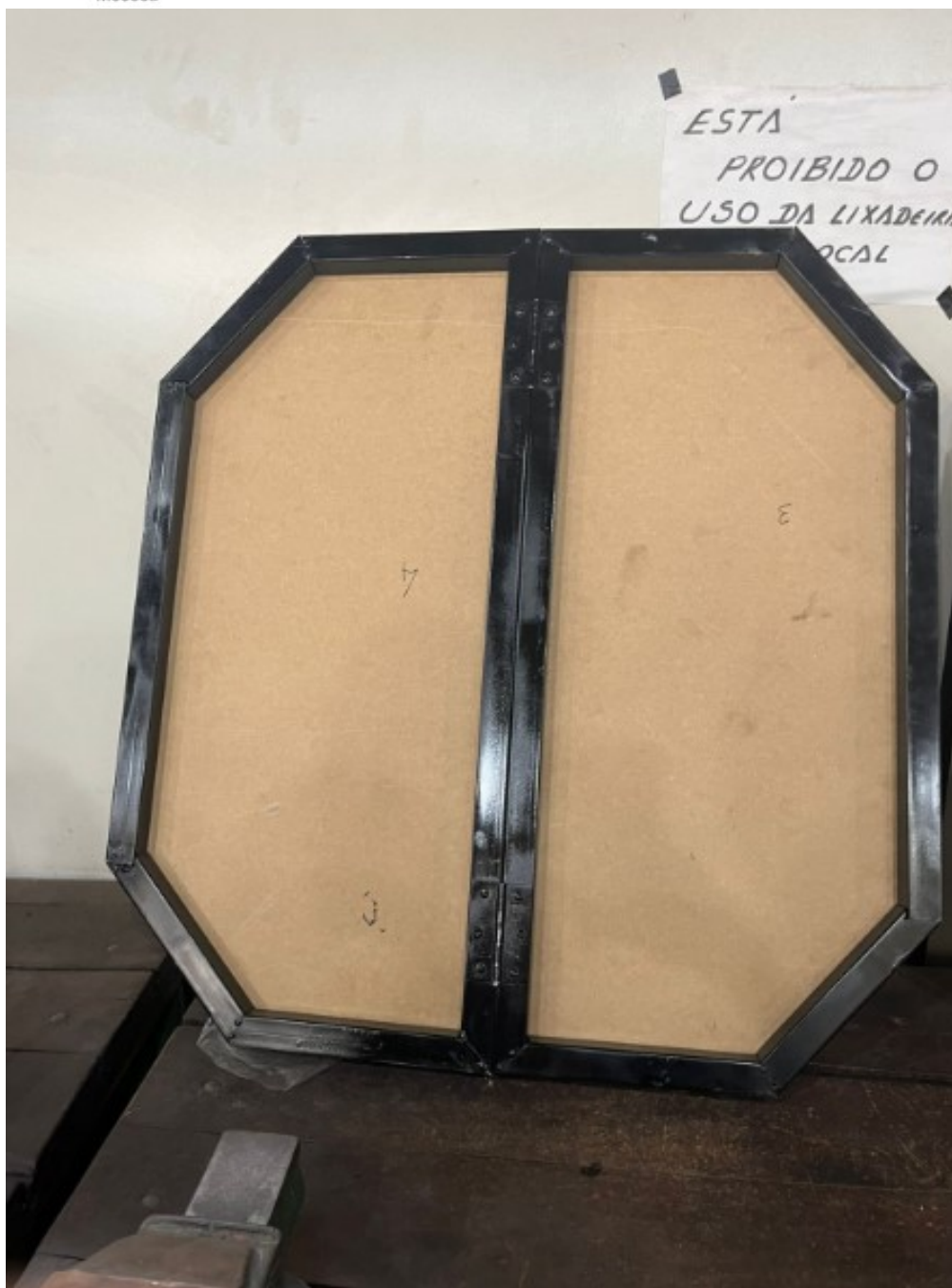
Figura 21 – Vista inferior pronta após fixação da madeira no metalon
