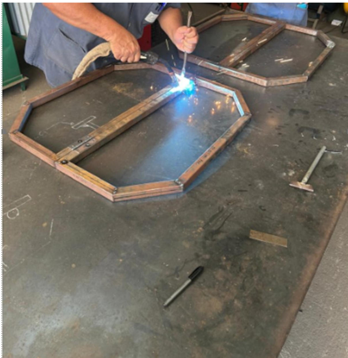
Figura 14 - Soldagem das dobradiças na base da mesa
