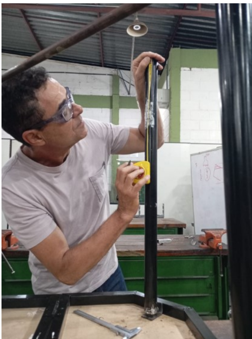
Figura 28 - Medindo os pés da mesa para fazer um furo passante para encaixar os suporte do pé
