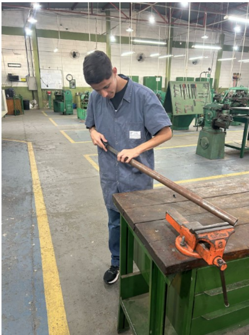
Figura 11 - Correção dos pés após corte na serra
