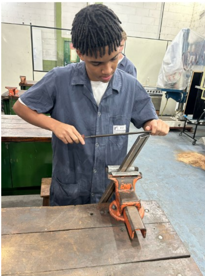
Figura 6 – Acabamento manual com lima rebarbamento
