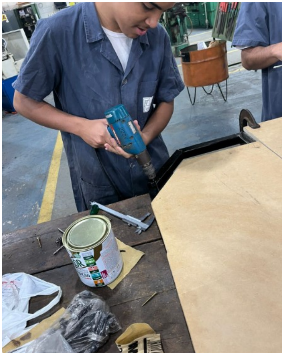
Figura 19 - Fixação da madeira com parafuso após o corte
