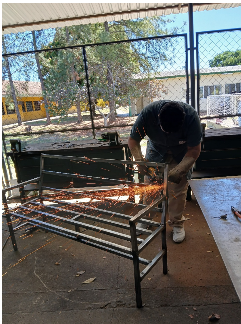
Figura 23 – Acabamento da solda do encosto com a esmerilhadeira.
