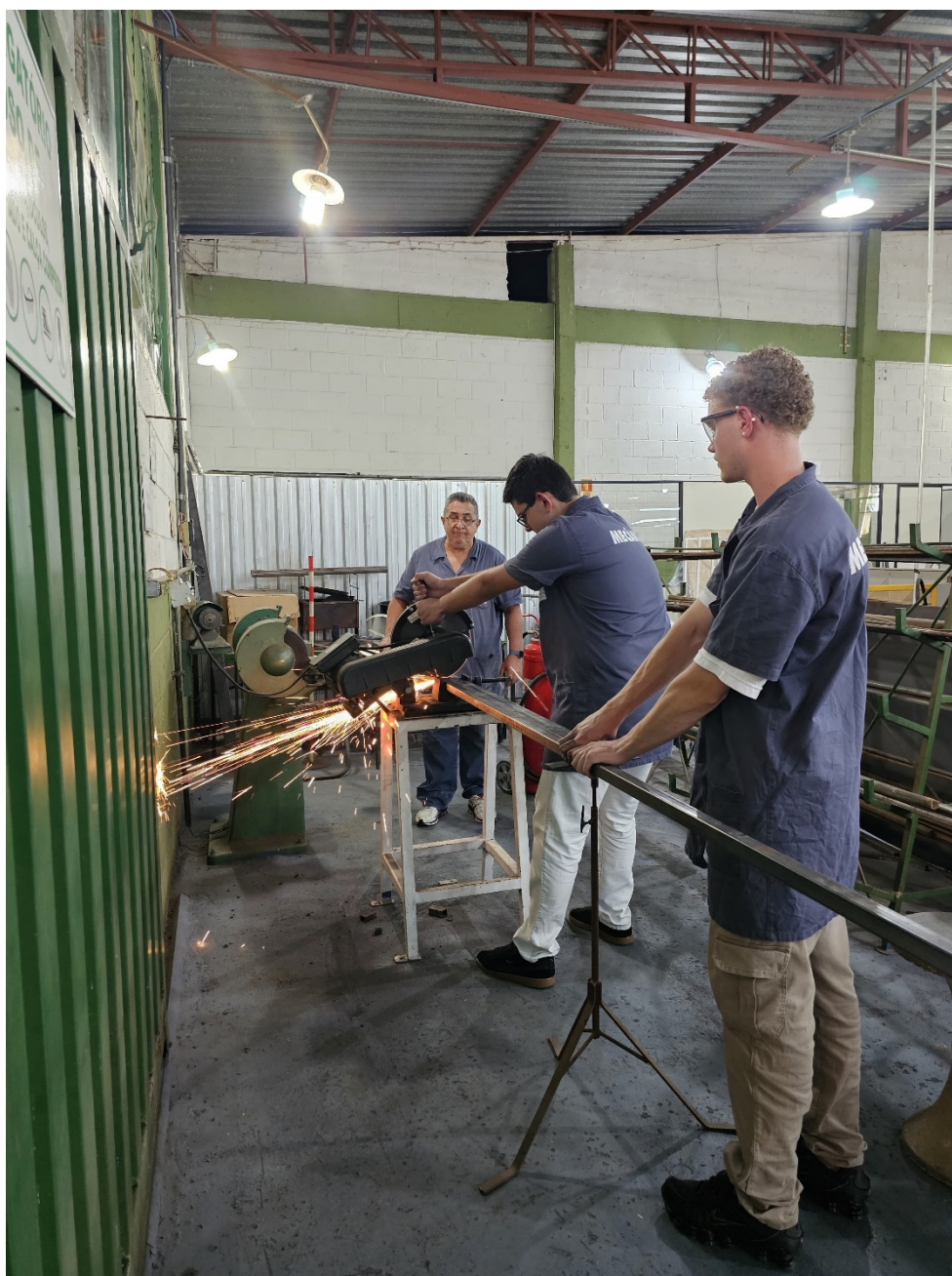
Figura 8 – Corte dos metalons utilizando a serra poli corte.
