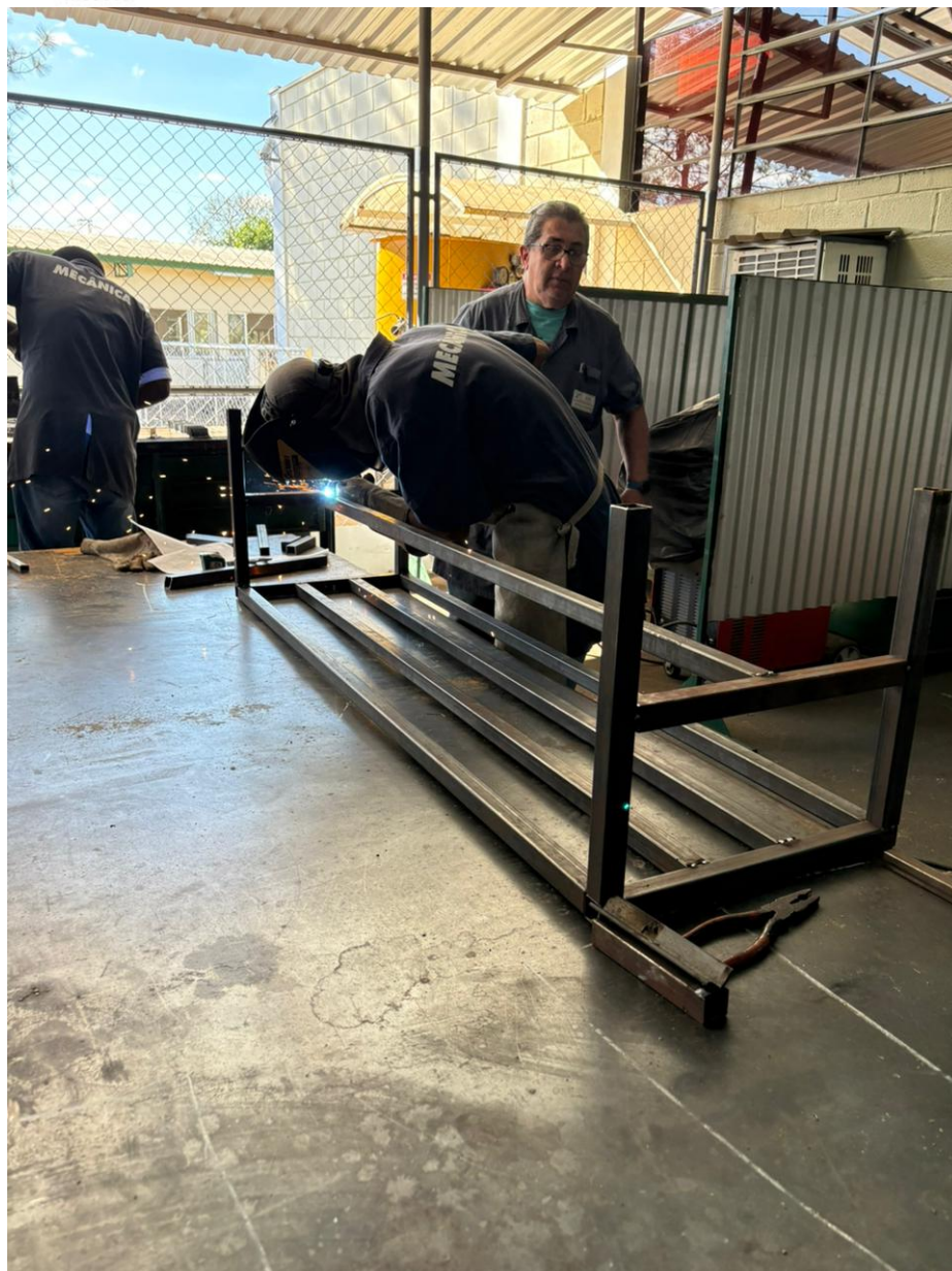
Figura 18 – Soldagem da trava dos pés.
