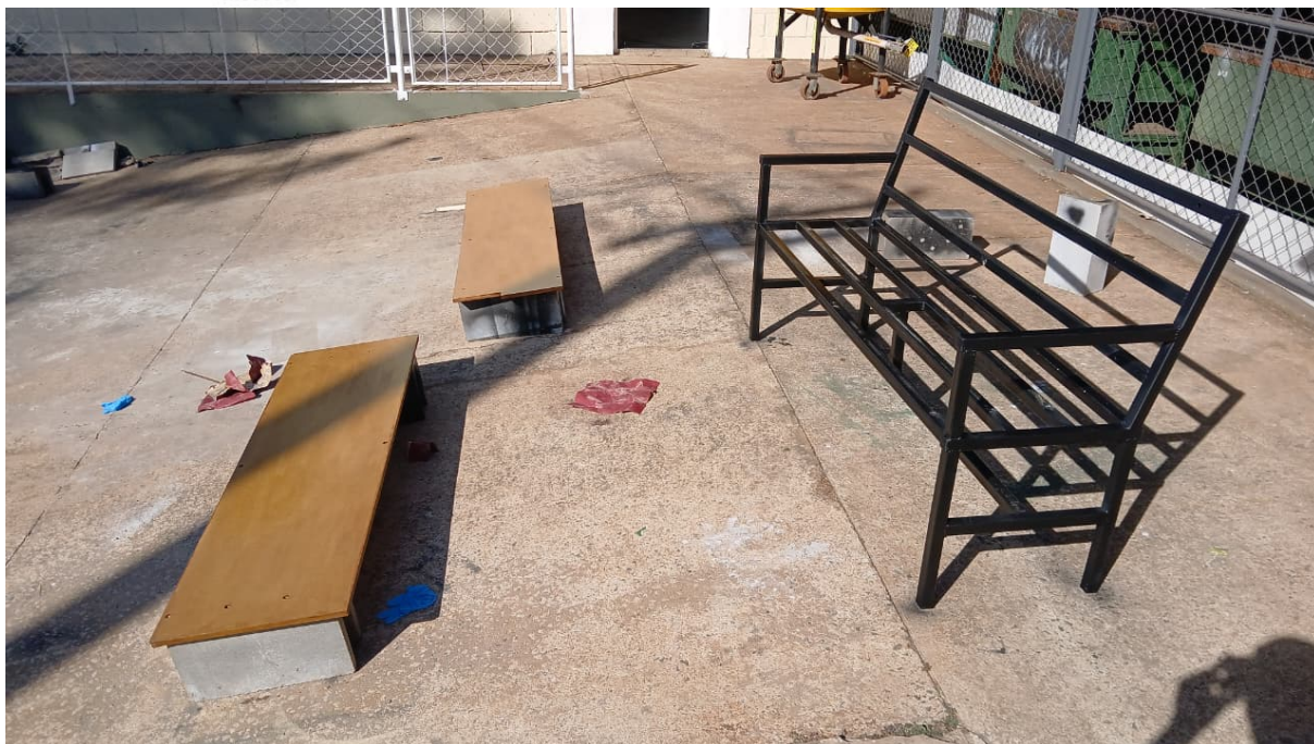
Figura 34 – Acabamento final na estrutura e MDF.
