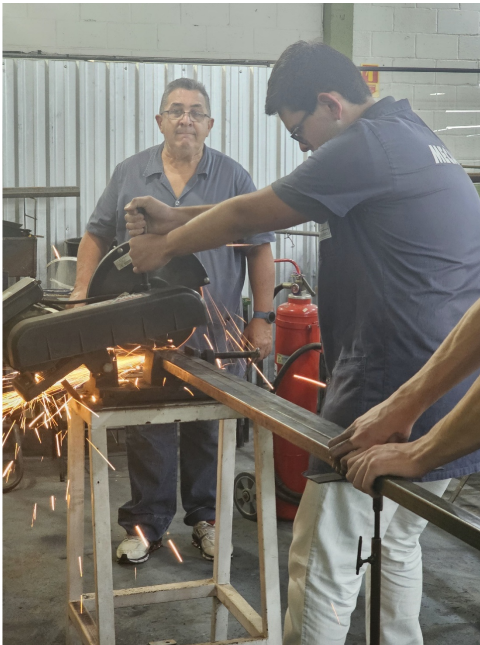
Figura 9 – Corte dos metalons utilizando a serra poli corte.
