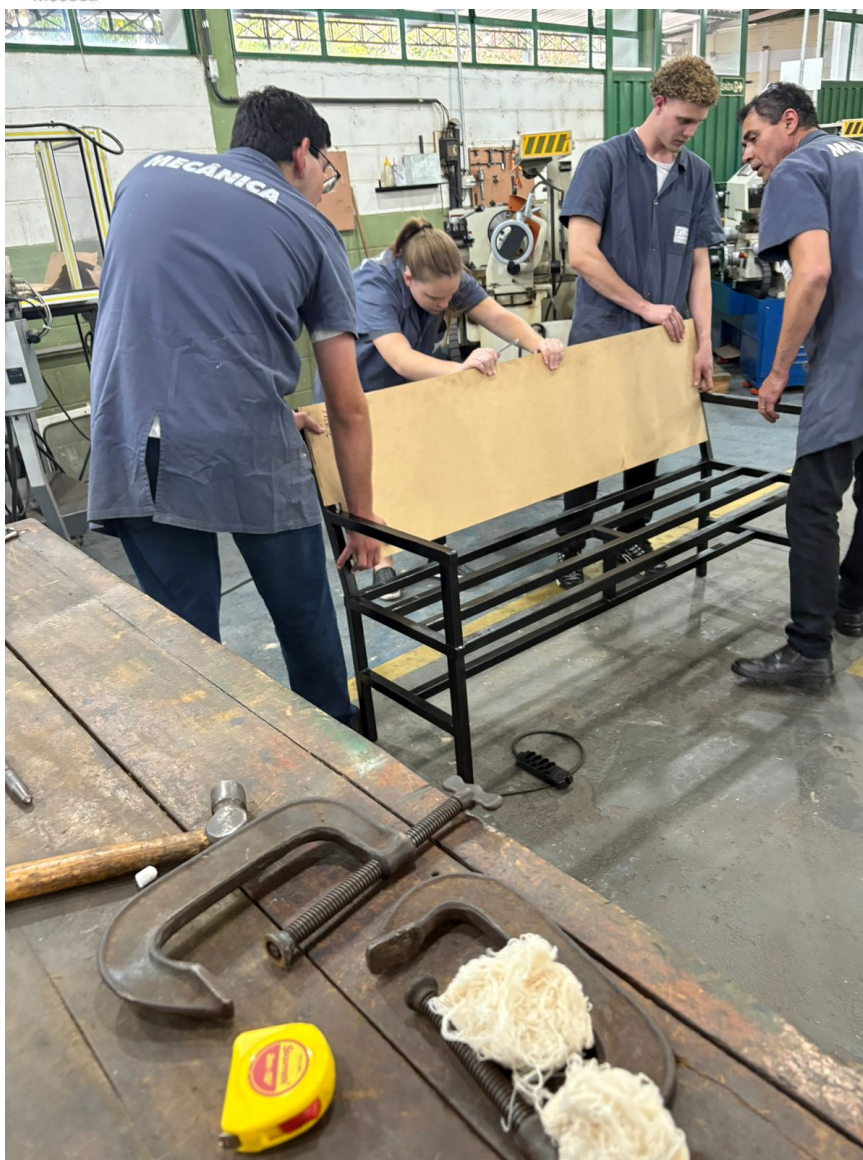
Figura 29 – Marcação da madeira antes de furar.
