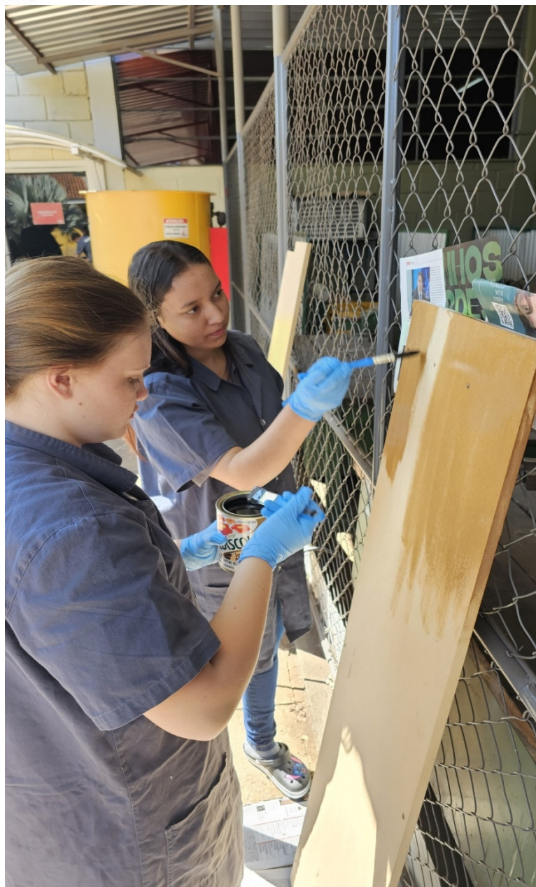
Figura 33 – Pintura do MDF com verniz.
