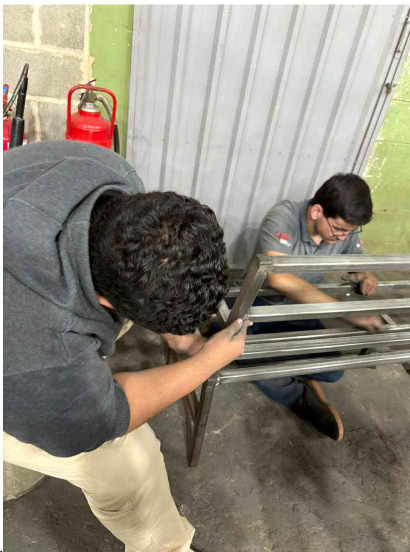
Figura 24 – Acabamento com lixa.
