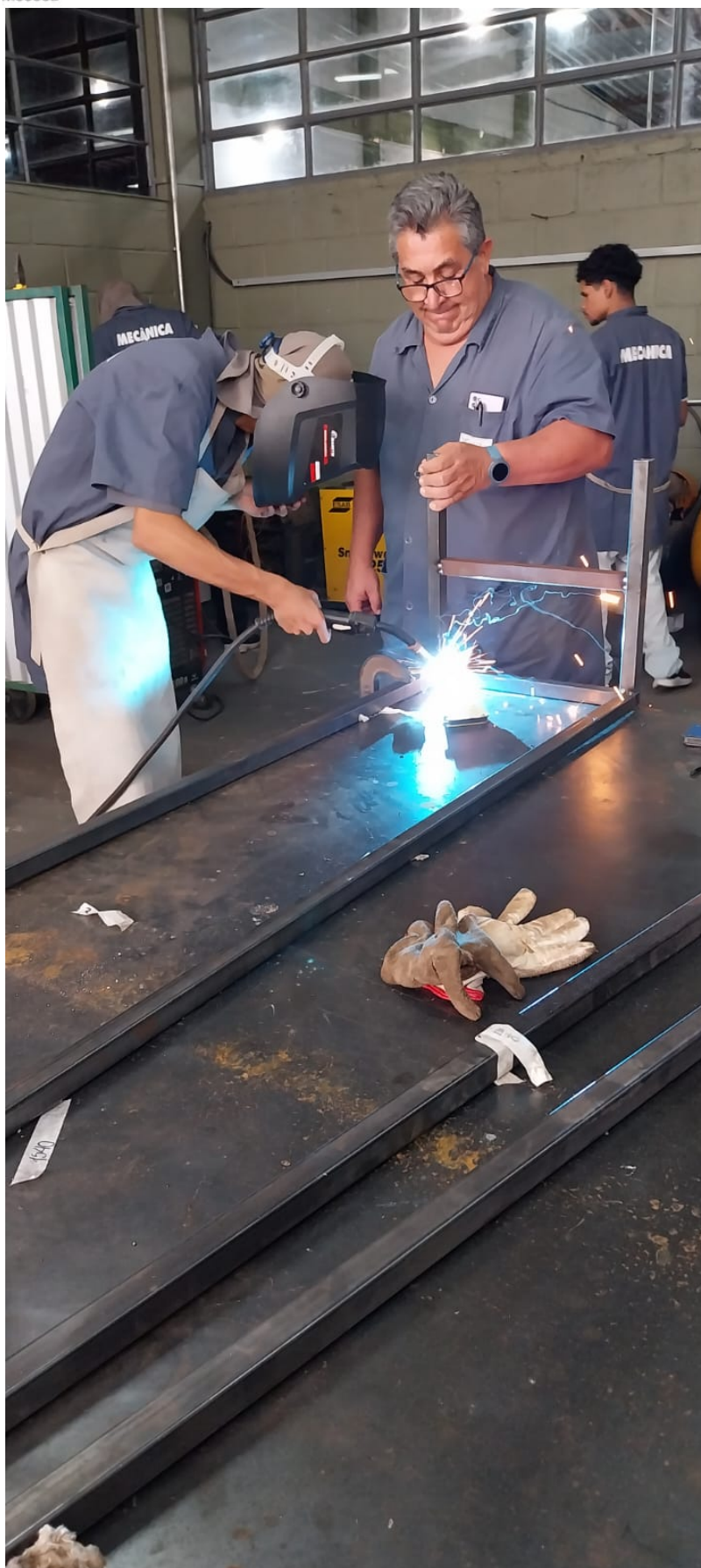
Figura 14 – Soldagem e montagem do assento.
