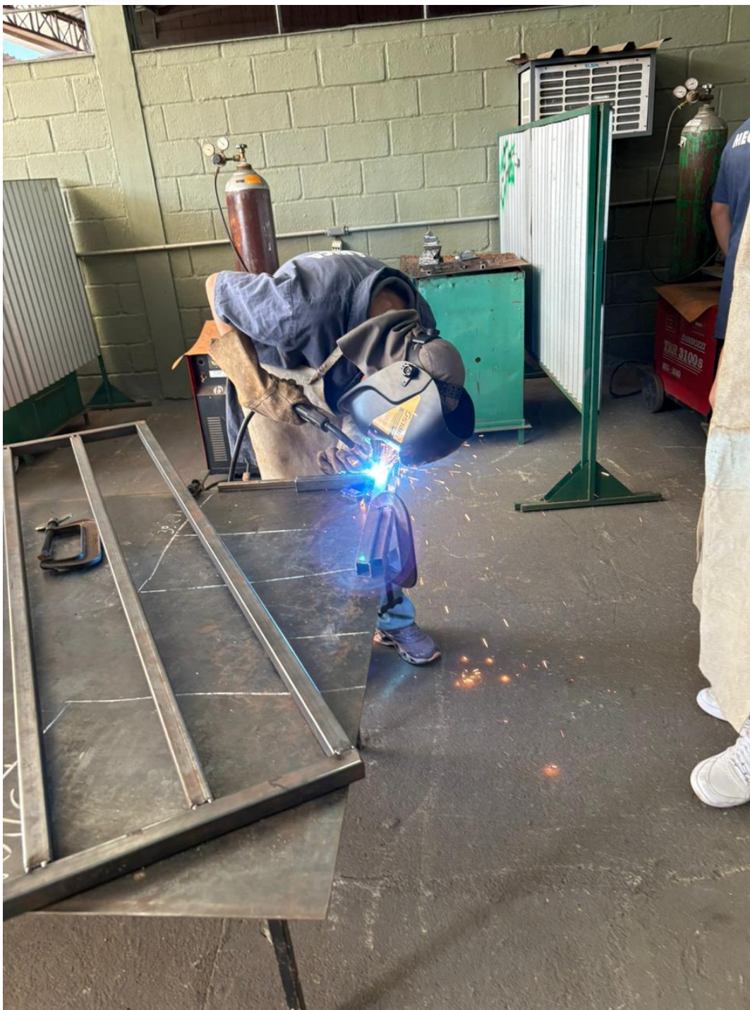
Figura 20 – Montagem do encosto de braço.
