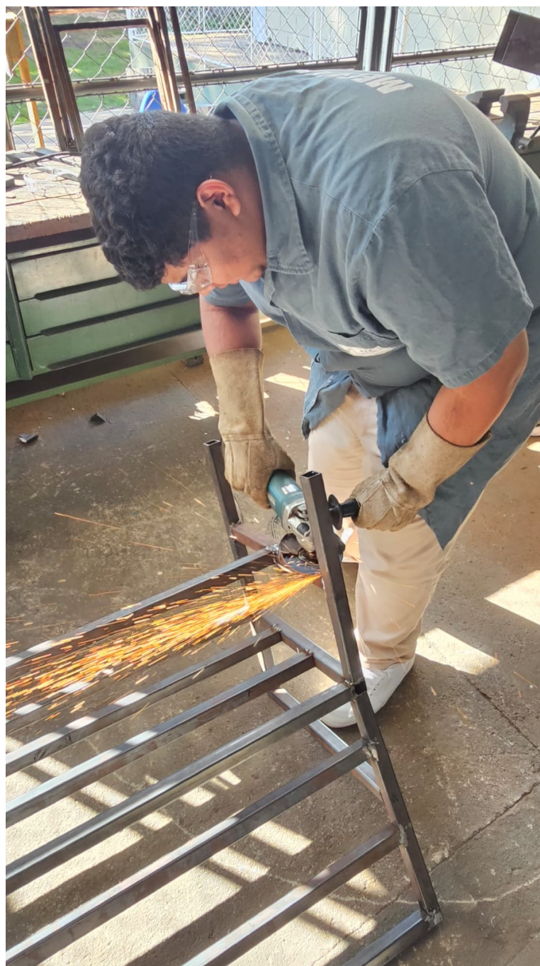
Figura 22 – Acabamento da solda do assento utilizando esmerilhadeira.
