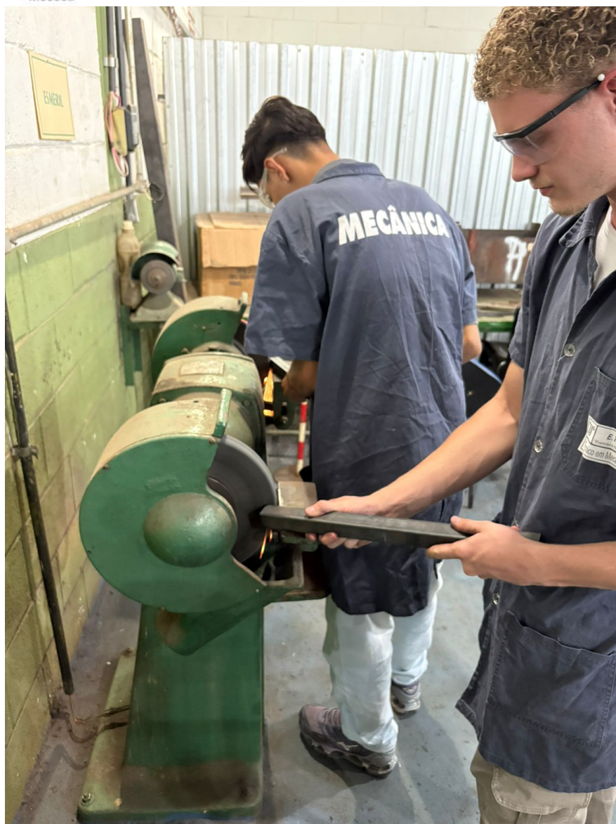
Figura 11 – Pré – acabamento dos metalons utilizando esmerilhadeira de bancada.
