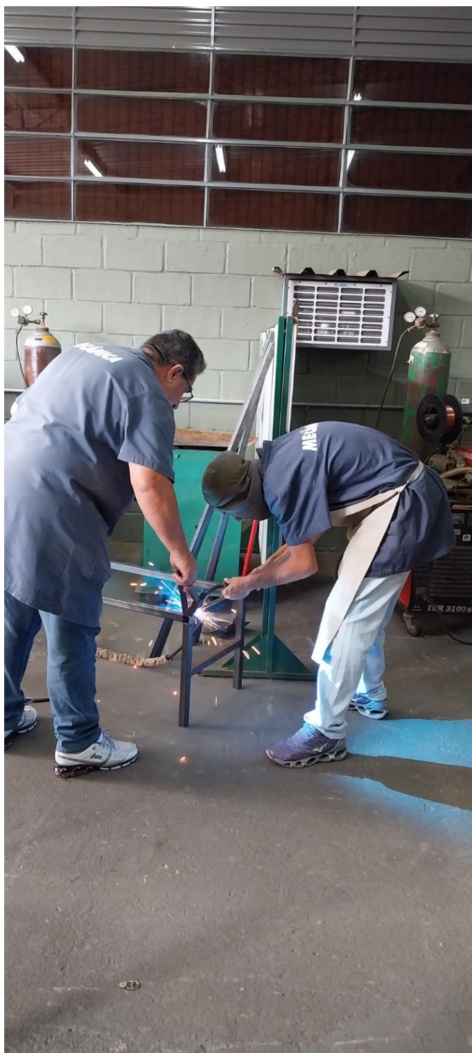
Figura 15 – Soldagem e montagem do encosto.
