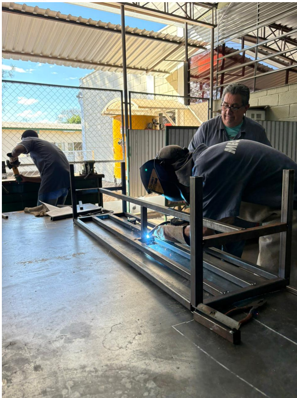
Figura 19 – Soldagem do reforço central em T.
