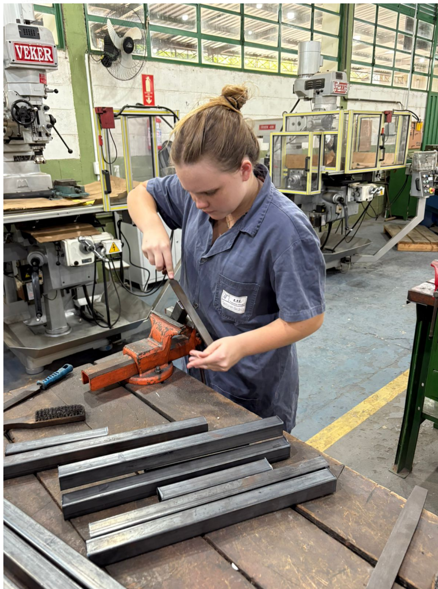
Figura 12 – Pré- acabamento utilizando lima grossa.
