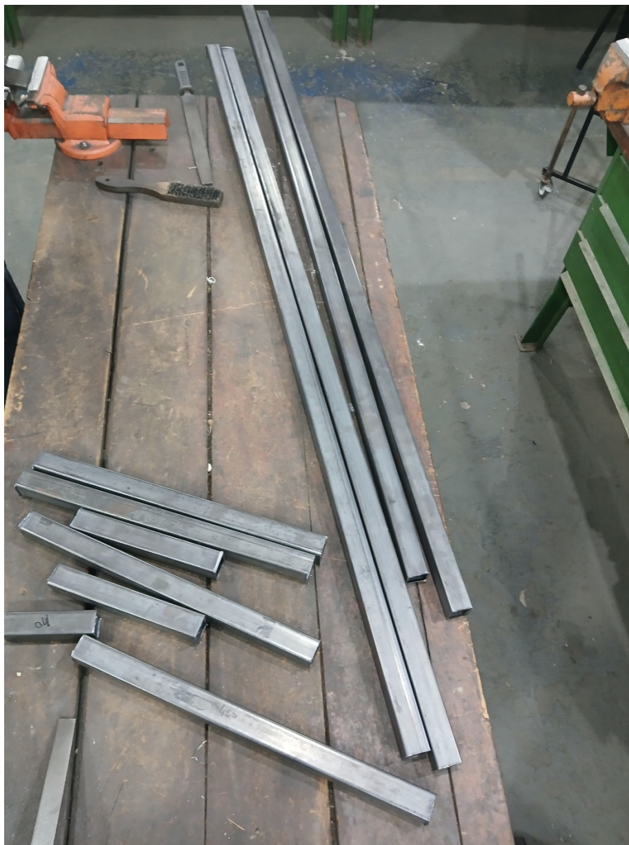
Figura 10 – Alguns dos metalons da estrutura já cortados.
