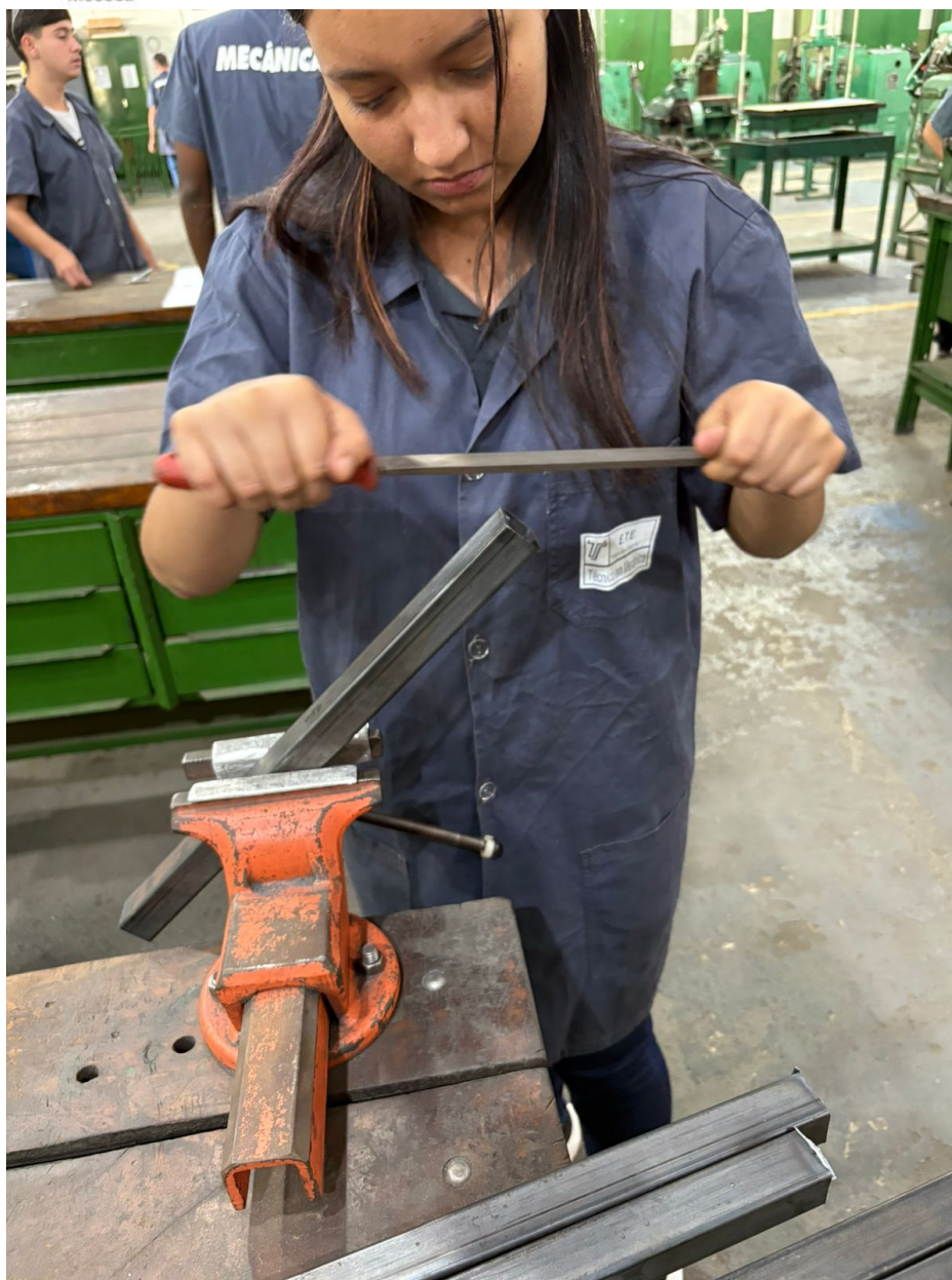
Figura 13 – Pré – acabamento utilizando lima grossa.
