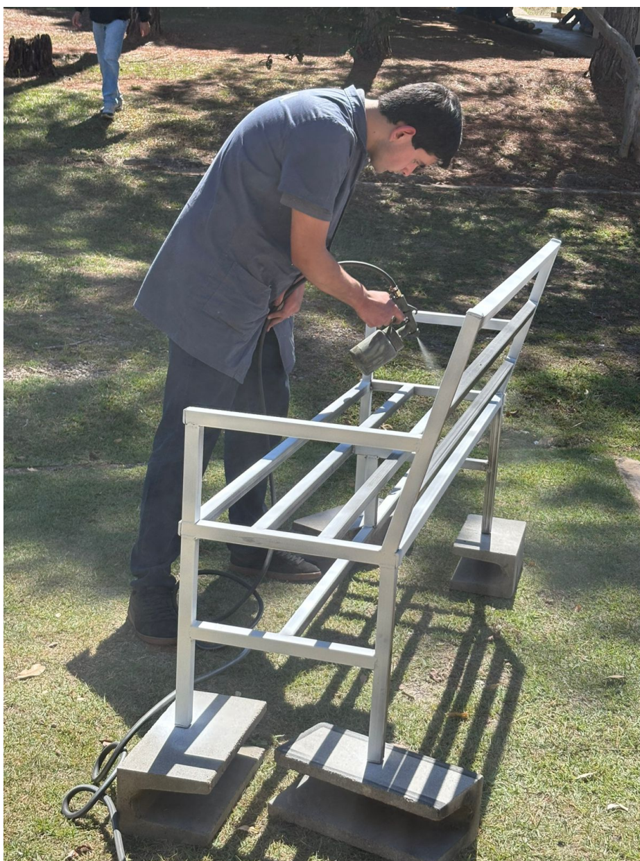
Figura 25 - Pintura com primer.
