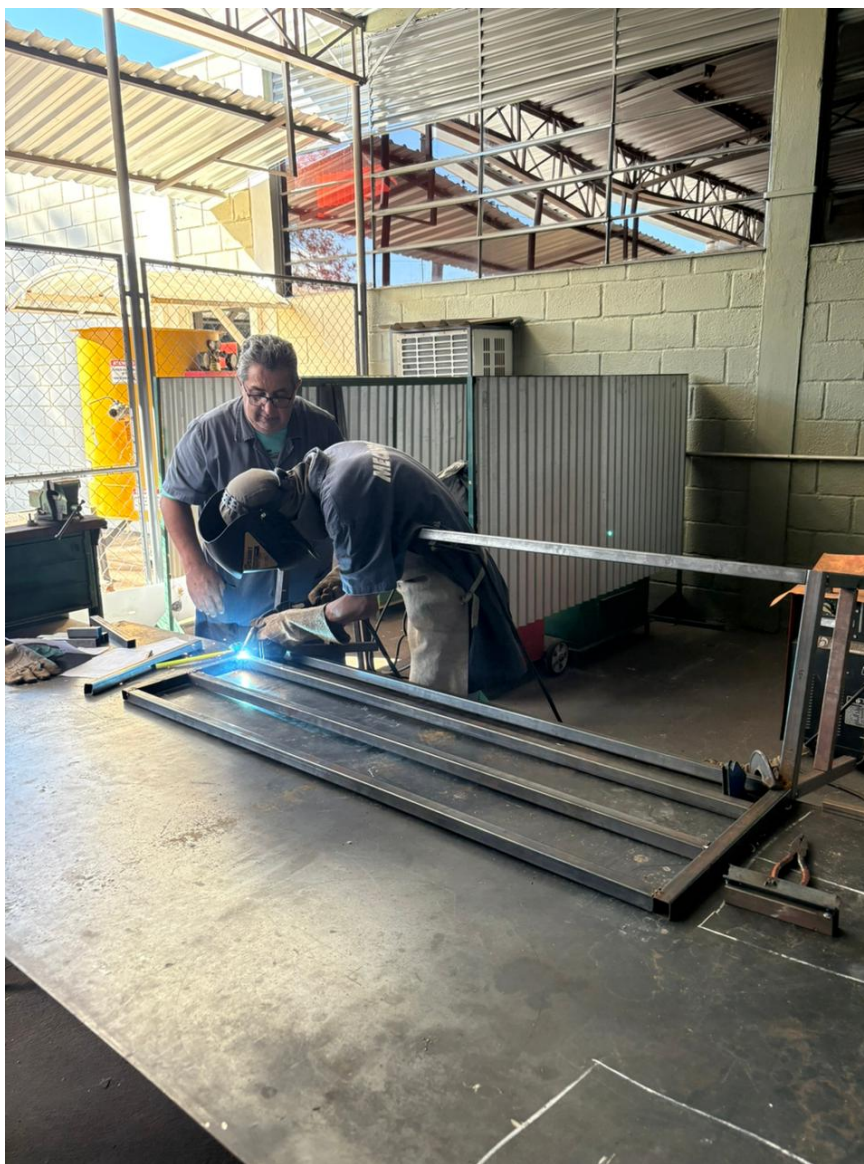
Figura 16 – Soldagem dos reforços do encosto.
