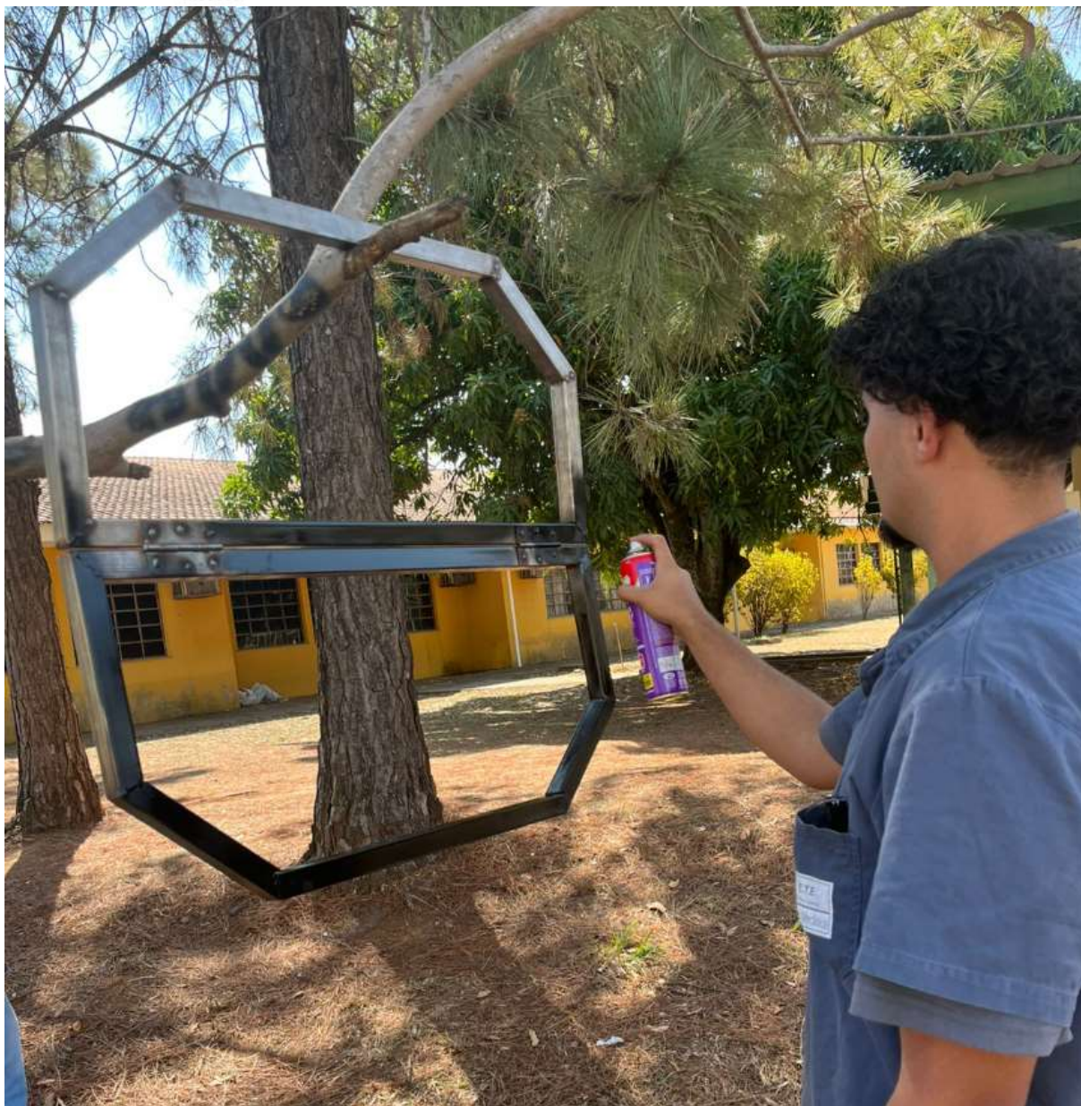
Figura 17 - Pintura da base após medir para o corte
