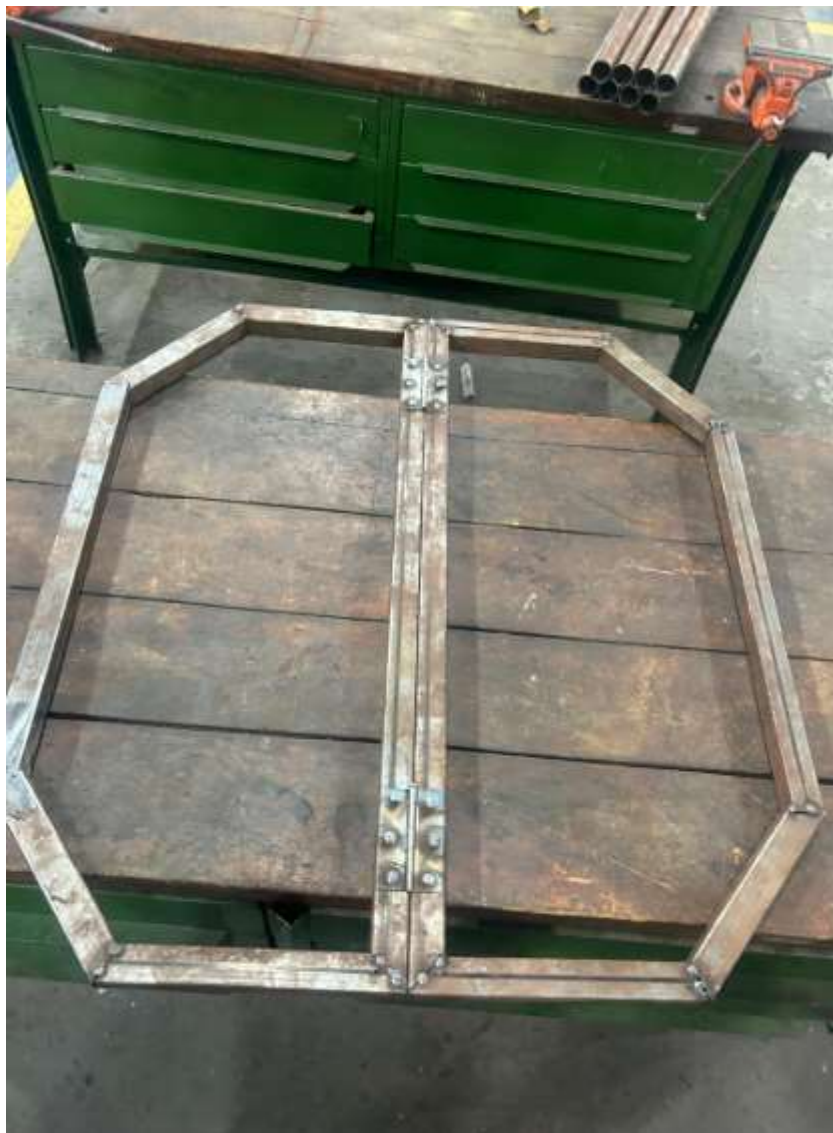
Figura 15 - Após soldagem das dobradiças a base pronta
