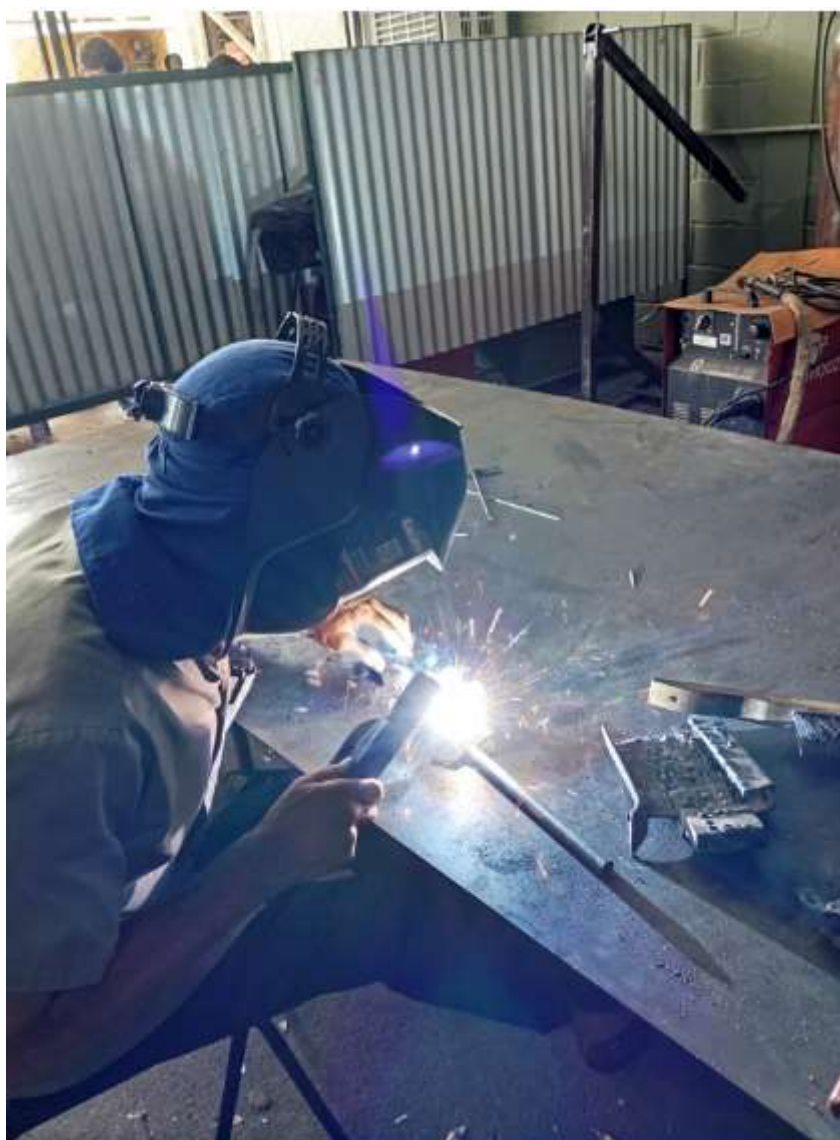
Figura 26 - Soldagem dos encaixe dos pé
