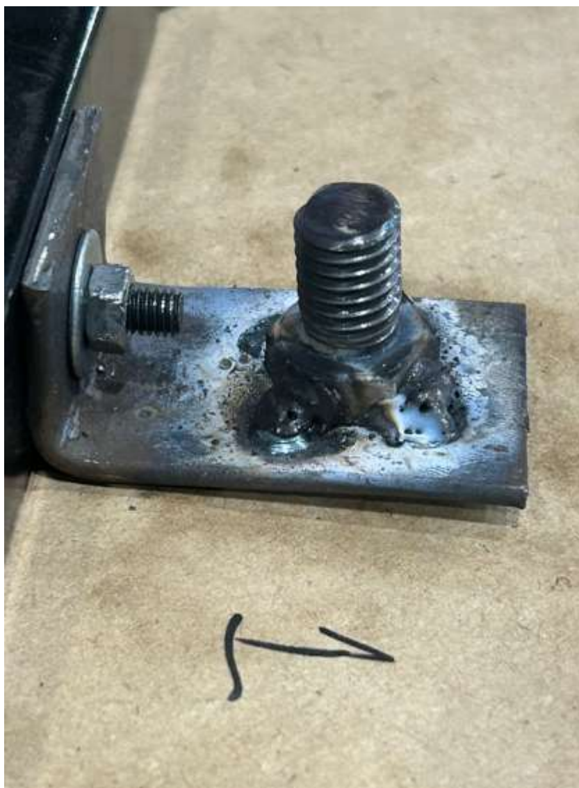
Figura 25 - Corte do parafuso, e fixação da chapa de apoio
