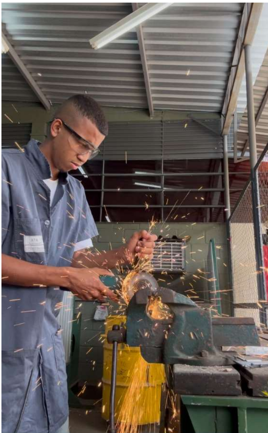
Figura 23 - Corte dos parafusos com a esmerilhadeira
