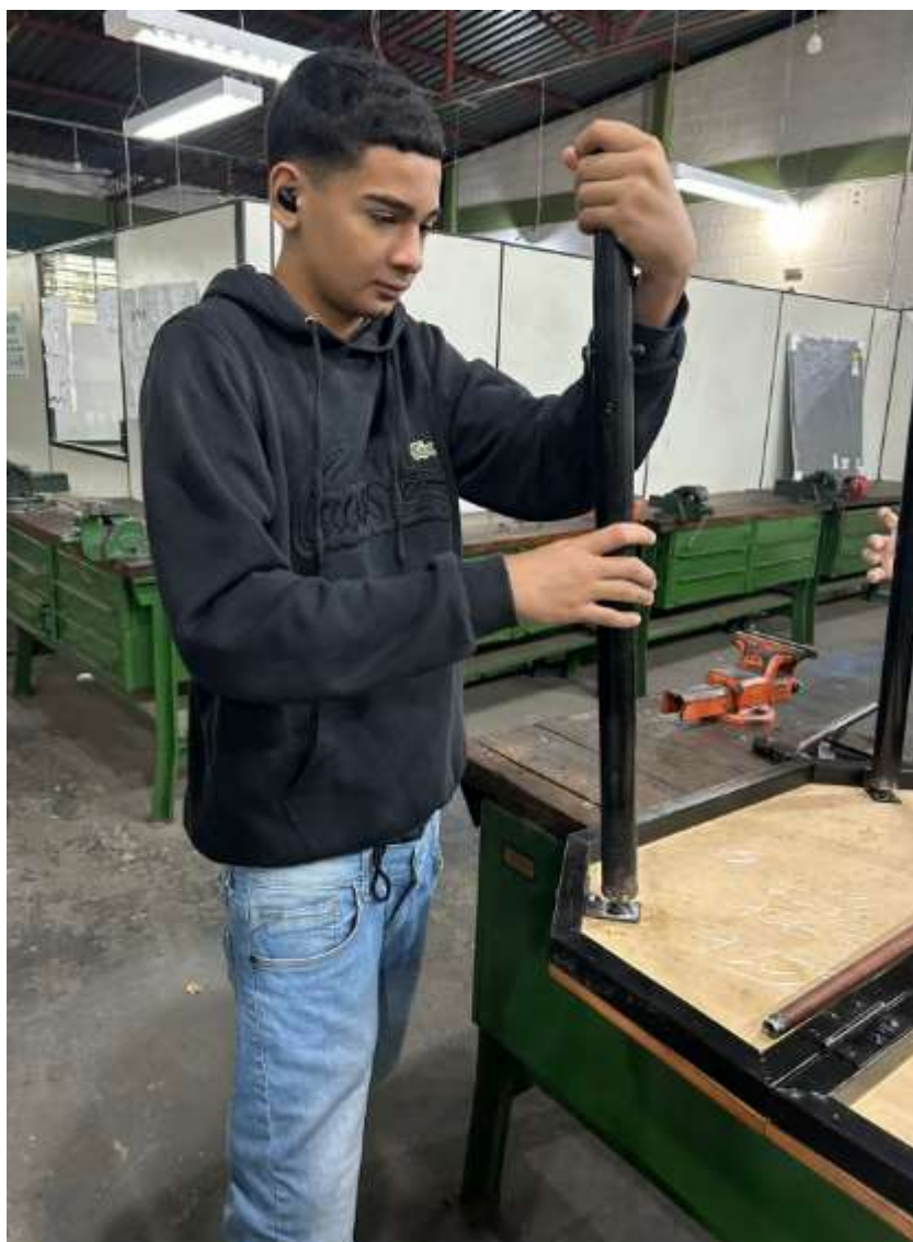
Figura 27 –Teste do pé da mesa com rosca fixadora
