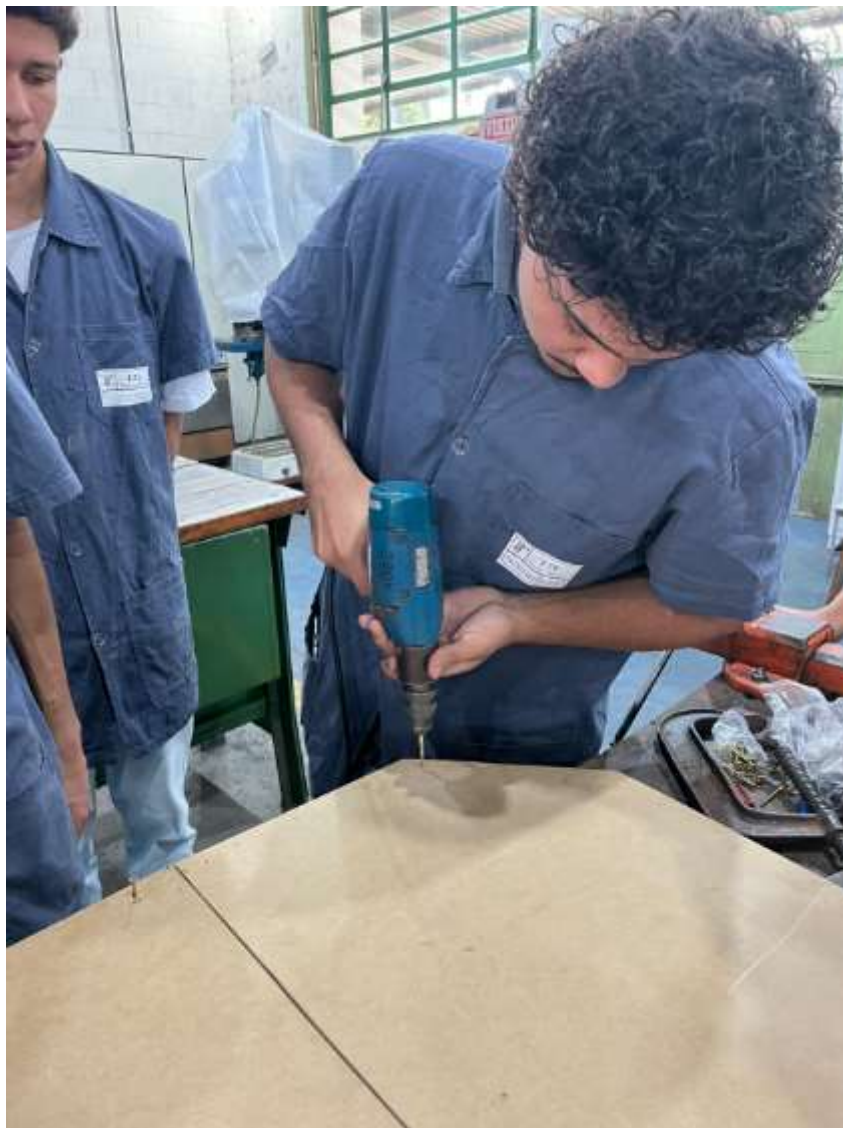
Figura 19 - Fixando a madeira na base da mesa
