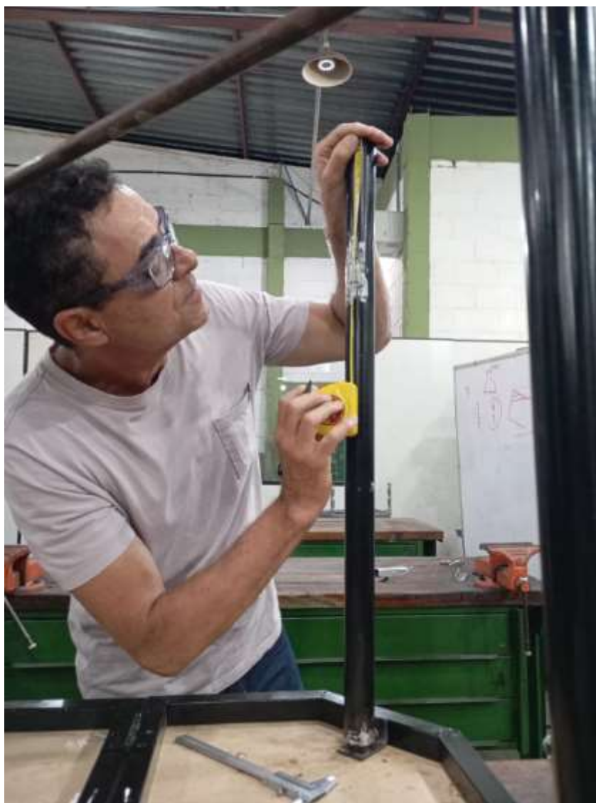
Figura 28 – Medição dos pés com um furo passante para que a mesa não fique bamba
