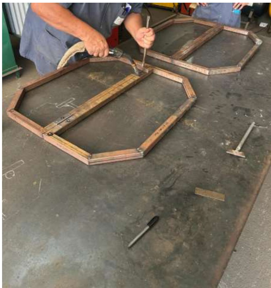
Figura 14 - Soldagem das dobradiças na base
