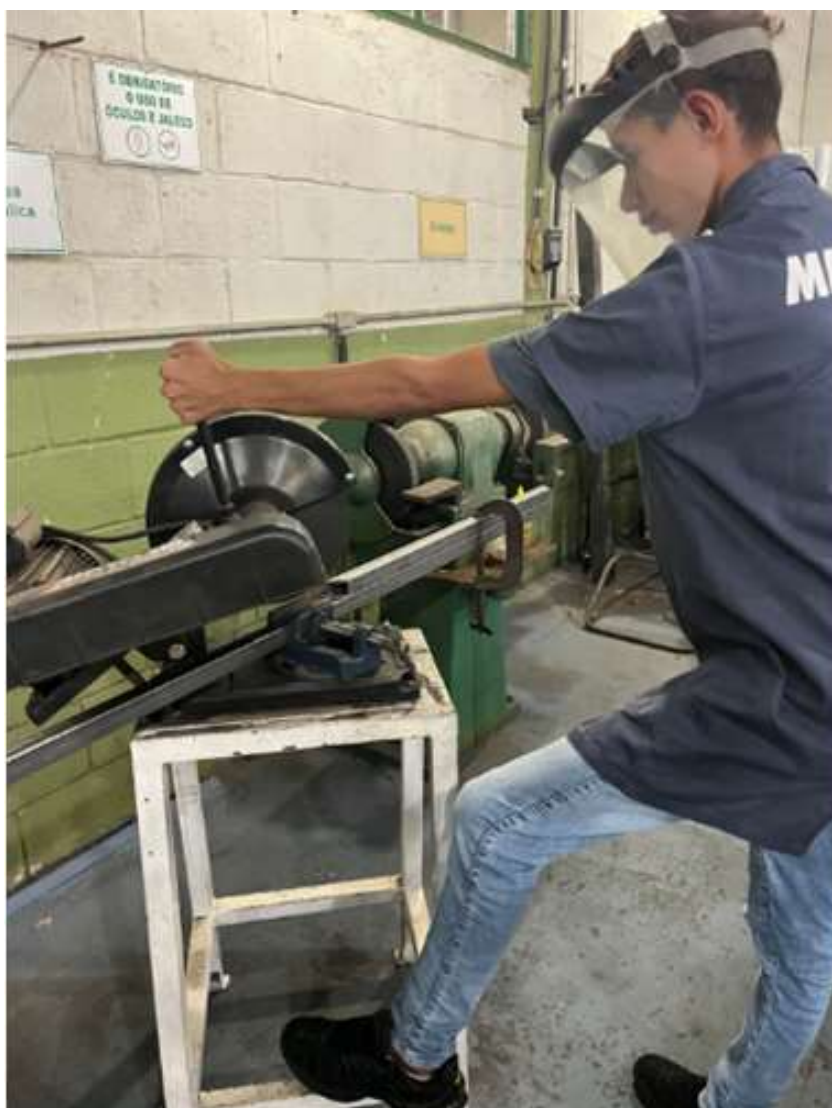
Figura 4 - Corte das barras utilizando o policorte
