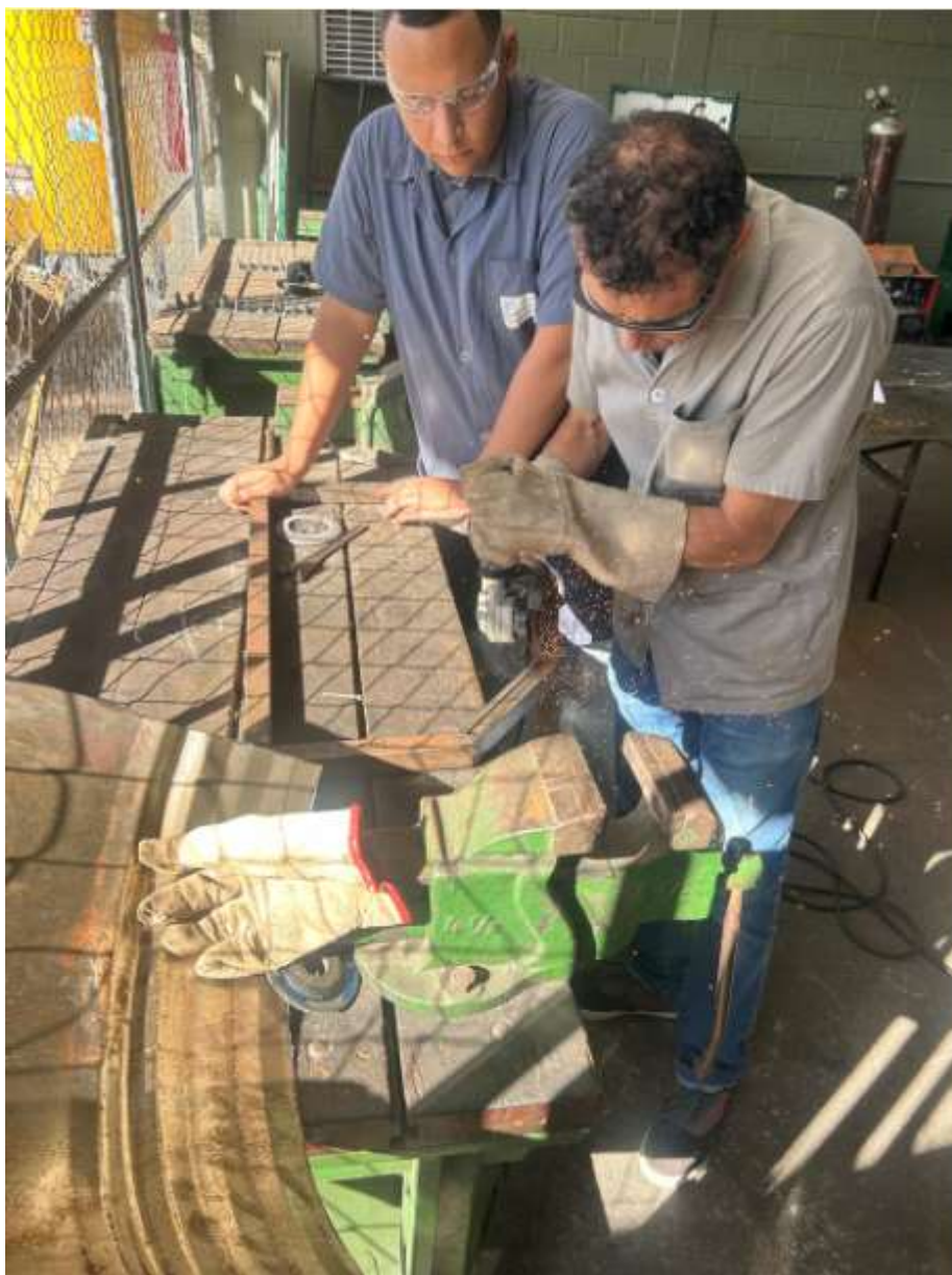
Figura 7 – Corte da base com esmerilhadeira
