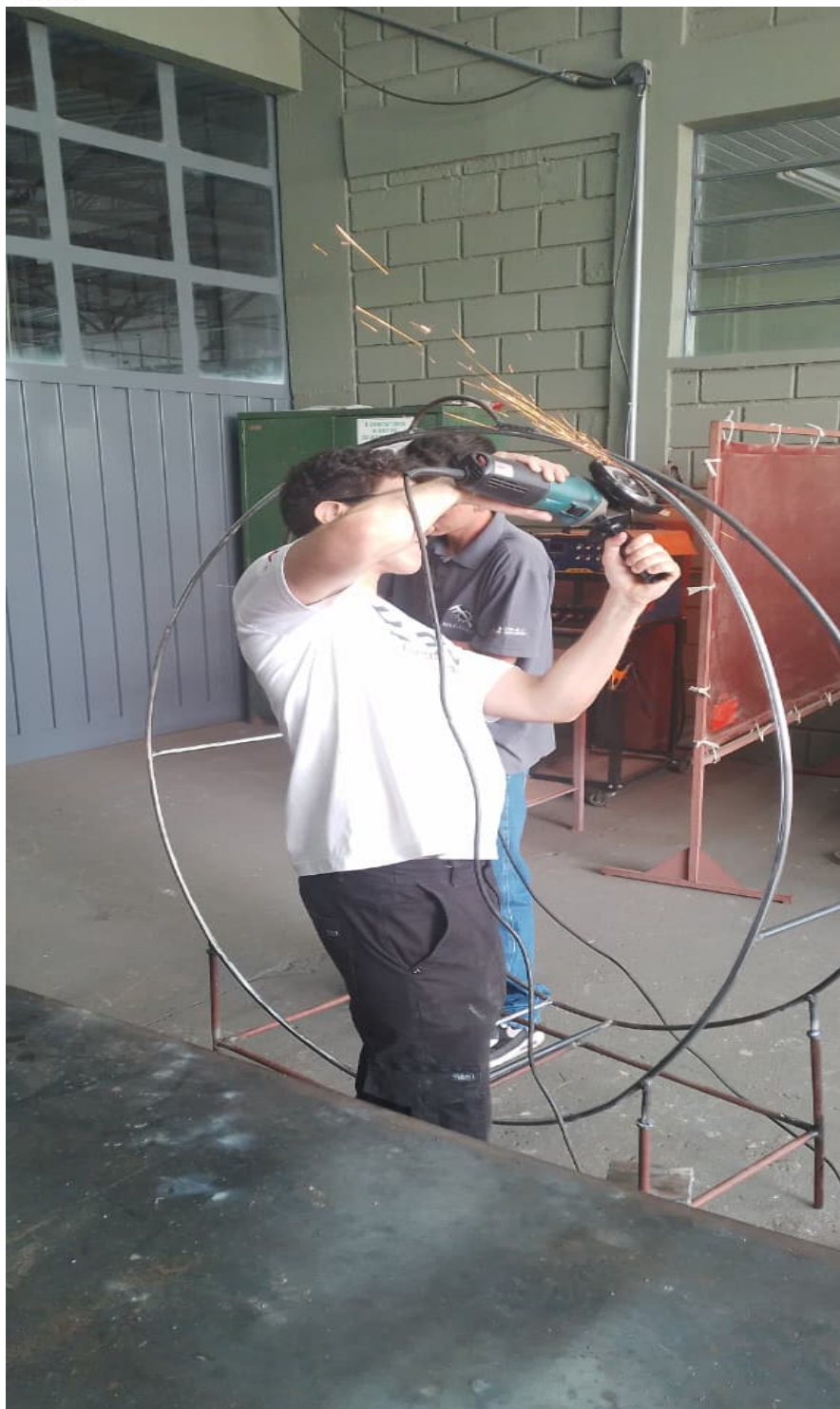
Figura 6 – Acabamento com esmerilhadeira. Ajustagem e acabamento das soldas
