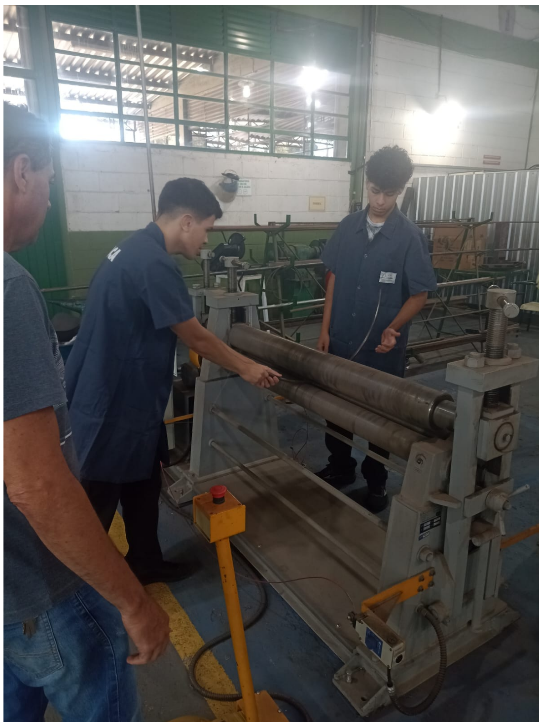
Figura 3 – Calandragem do perfil cilíndrico do aro do balanço
