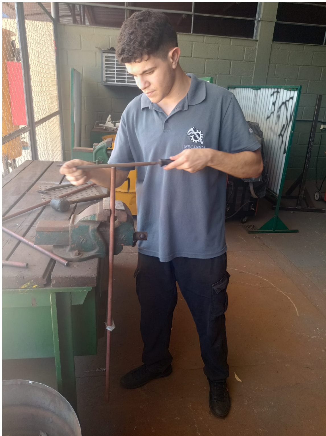
Figura 5 – Acabamento manual com limas. Ajustagem das “bocas de lobo”
