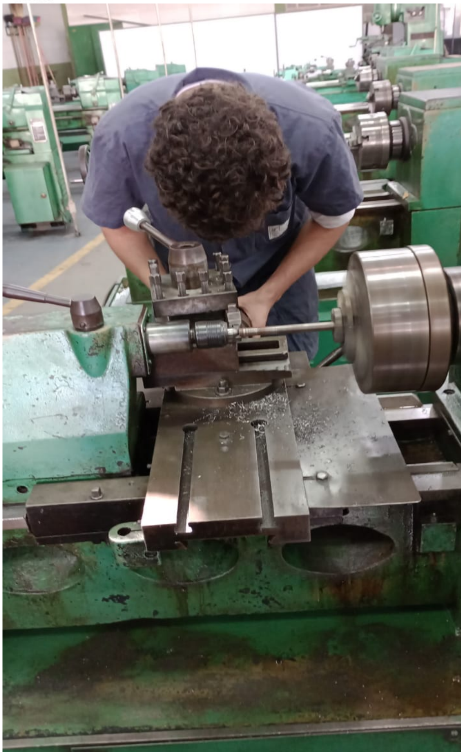
Figura 4 – Torneamento das peças conectoras da estrutura
