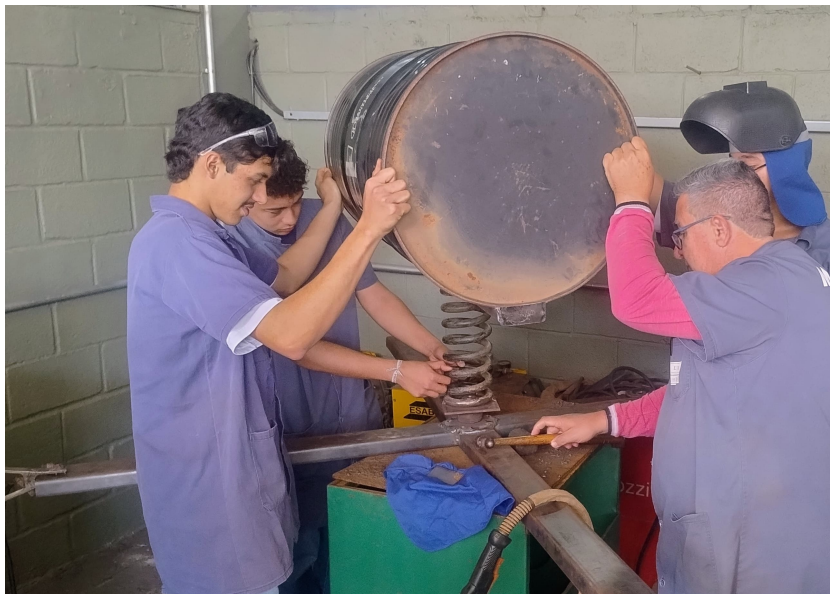
Figura 7 – Soldagem do tambor na estrutura inferior
