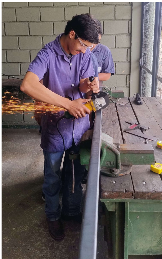
Figura 3 – Corte das vigas U para construção da parte inferior do touro
