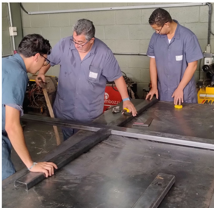
Figura 4 – Montagem e soldagem da cruzeta (estrutura inferior do touro)
