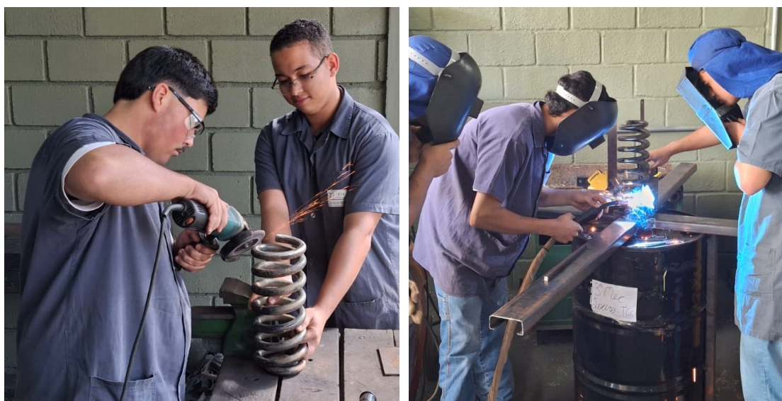
Figura 6 – Soldagem da mola (estrutura inferior do touro)
