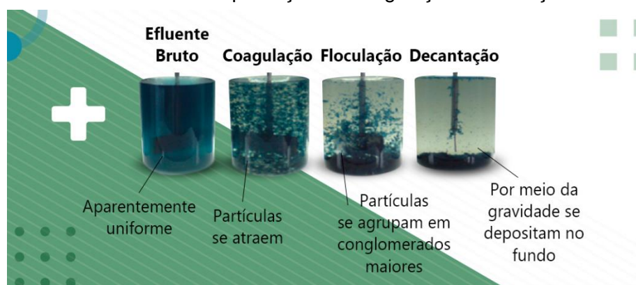
FIGURA 8: Exemplificação da coagulação e floculação
