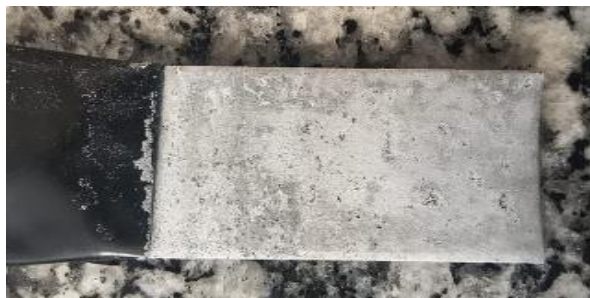
Figura 14. Cátodo de grafite utilizado
