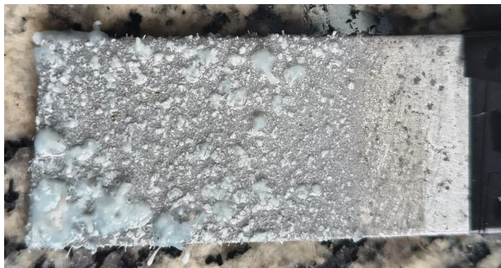
Figura 26. Cátodo pós eletrólise de água do mar
