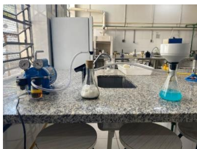
Figura 13: Sistema de filtração a vácuo.
