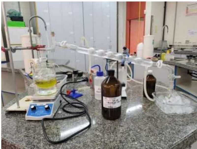
Figura 9: Destilação simples para separar o óleo essencial do hexano
