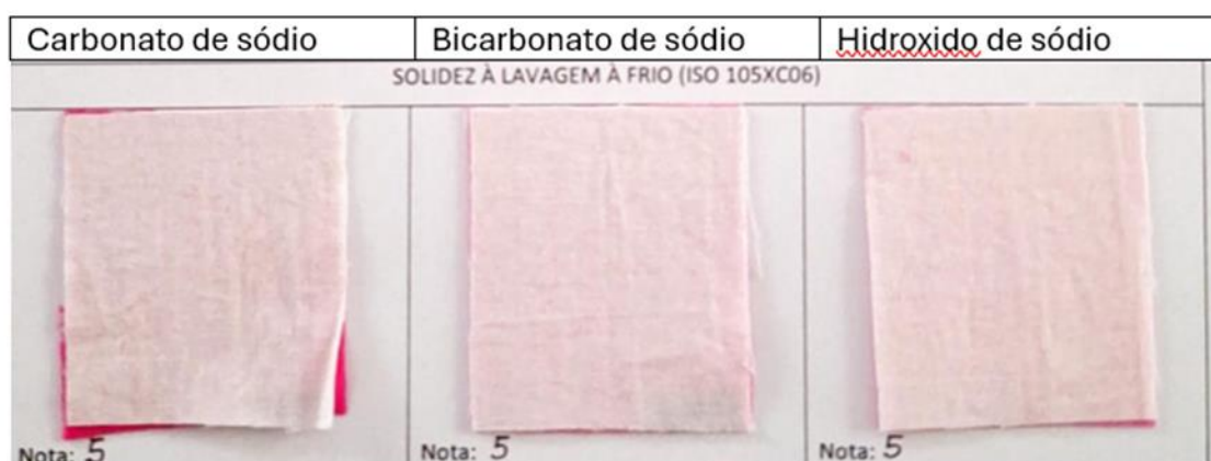
Figura 20: resultados visuais dos testes de solidez a lavagem realizados em tingimentos feitos com diferentes tipos de álcalis.
