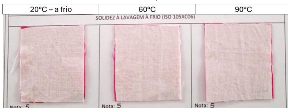
Figura 21: resultados visuais dos testes de solidez a lavagem realizados em tingimentos feitos com diferentes temperaturas
