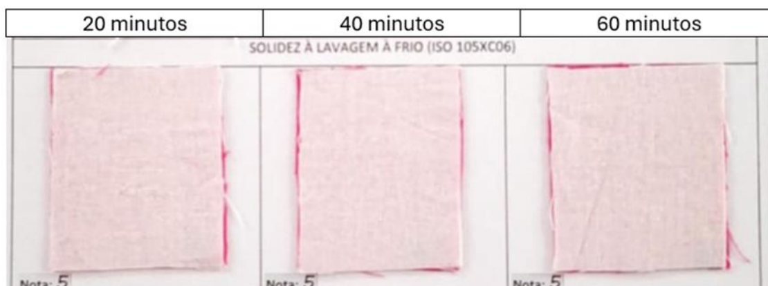
Figura 22: resultados visuais dos testes de solidez a lavagem realizados em tingimentos feitos com diferentes tempos de fixação.
