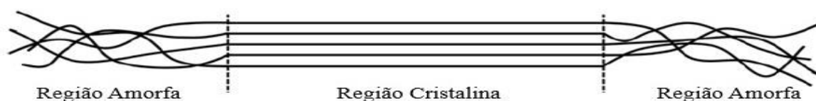
Figura 2: Representação esquemática das zonas cristalinas e das zonas amorfas nas cadeias de celulose
