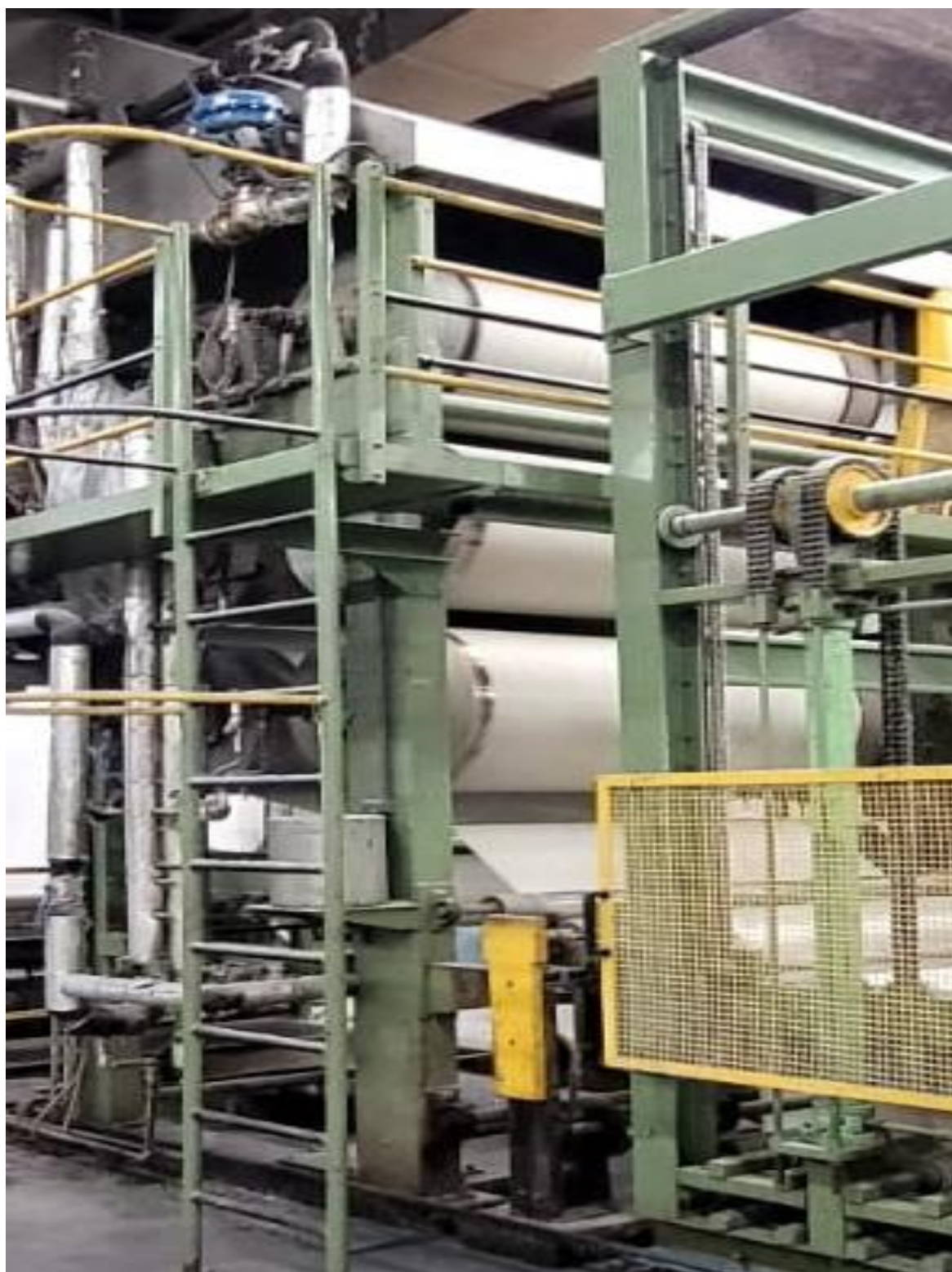
Figura 13: Coluna de tambores de secagem a vapor
