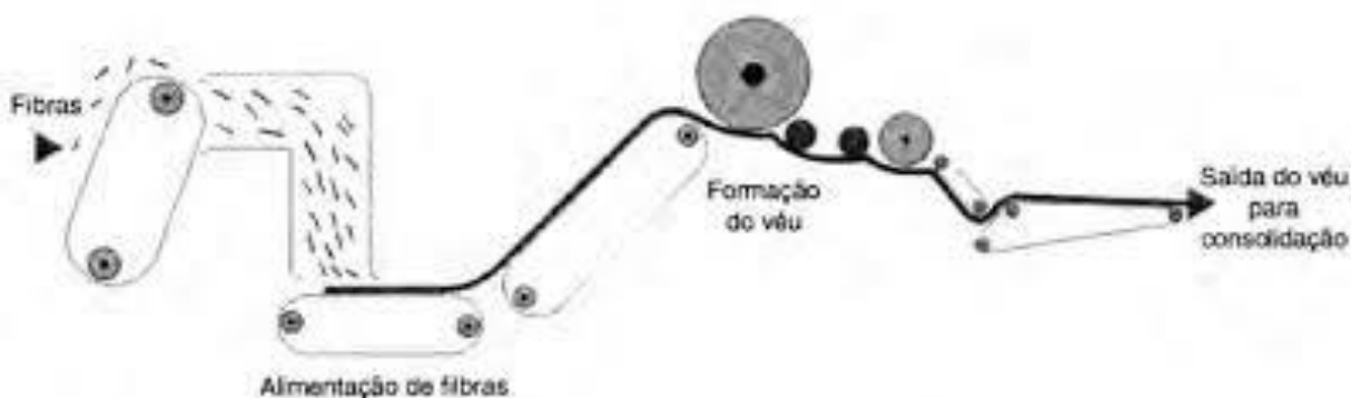
Figura 56: Processo de fabricação via aérea (fluxo de ar)
