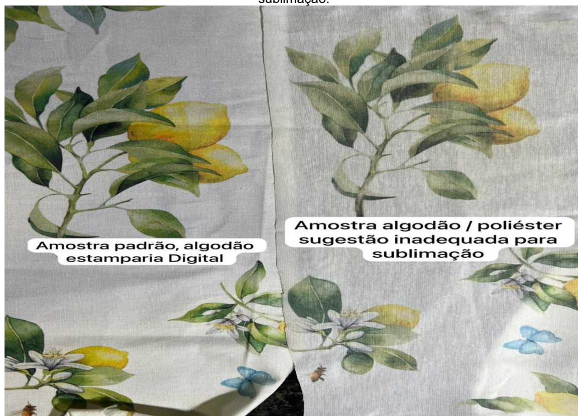
Figura 5: Comparação entre amostra inicial da cliente e a amostra feita na base inadequada para sublimação.
