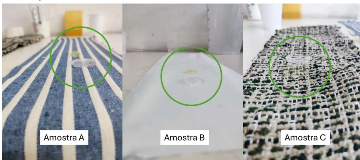
Figura 11 – Hidrorrepelencia e óleorrepelencia após aplicação de parafina
