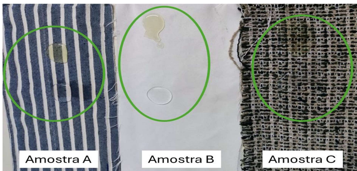
Figura 12 – Hidrorrepelencia e óleorrepelencia após 08 horas
