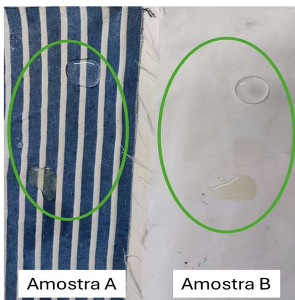
Figura 10 – Hidrorrepelencia e óleorrepelencia após lavagem
