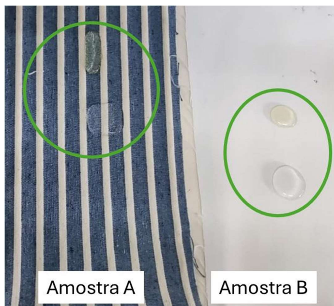
Figura 09 – Hidrorrepelencia e óleorrepelencia após aplicação de fluorcarbono
