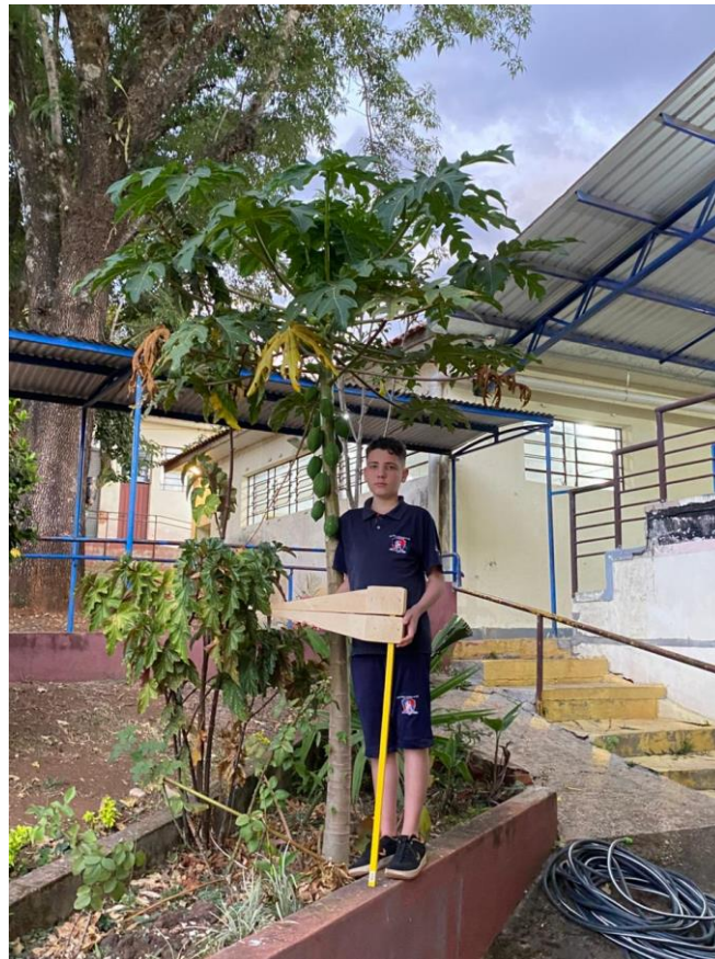
Figura 5: Instrumento de medição do D.A.P. (paquímetro). Fonte: Os autores.
