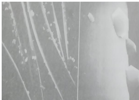
Figura 7-Fio de poliéster com oligômeros
