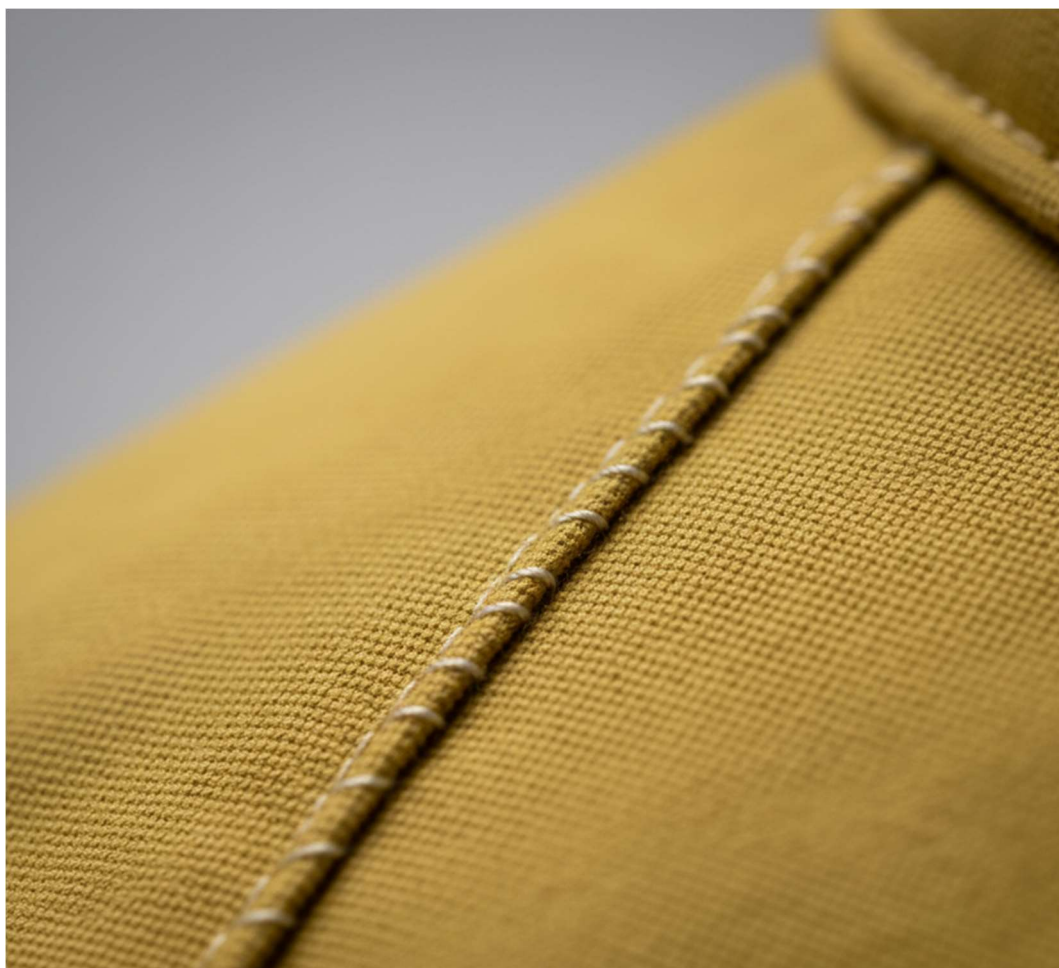
Figura 5 - Detalhe de costura em área crítica de uniforme de bombeiro, evidenciando a descontinuidade estrutural
