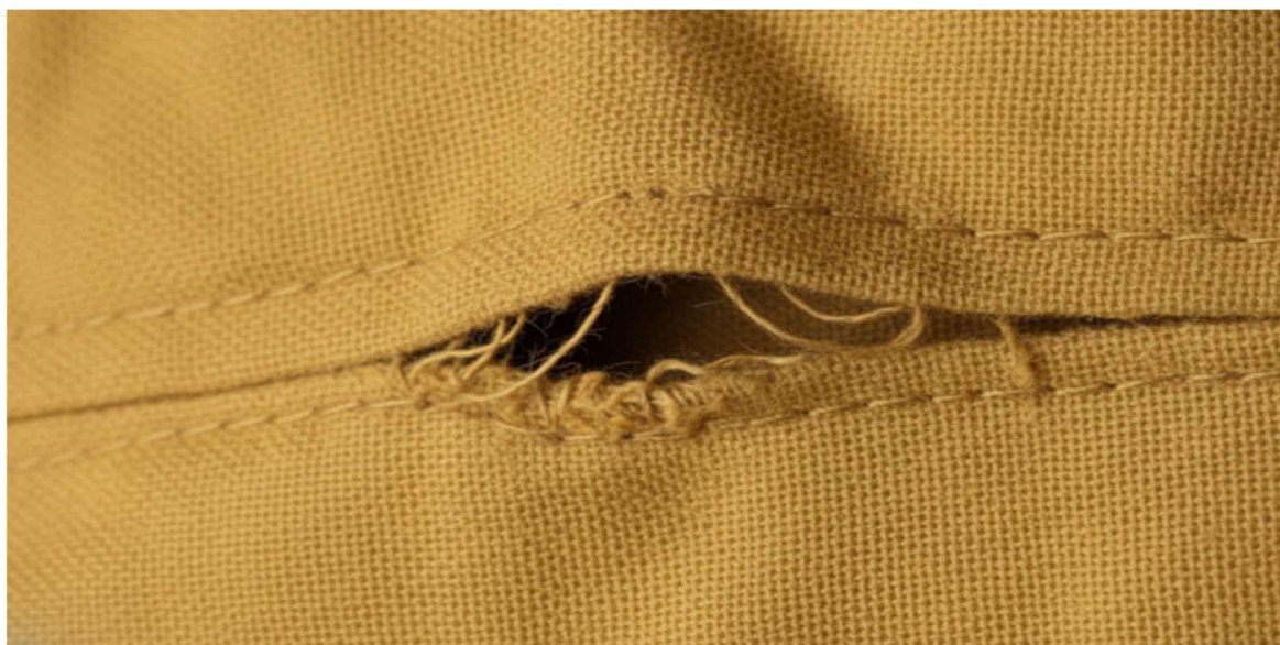
Figura 6 – Exemplo de falha de costura, ilustrando o risco de abertura do uniforme em condições extremas.
