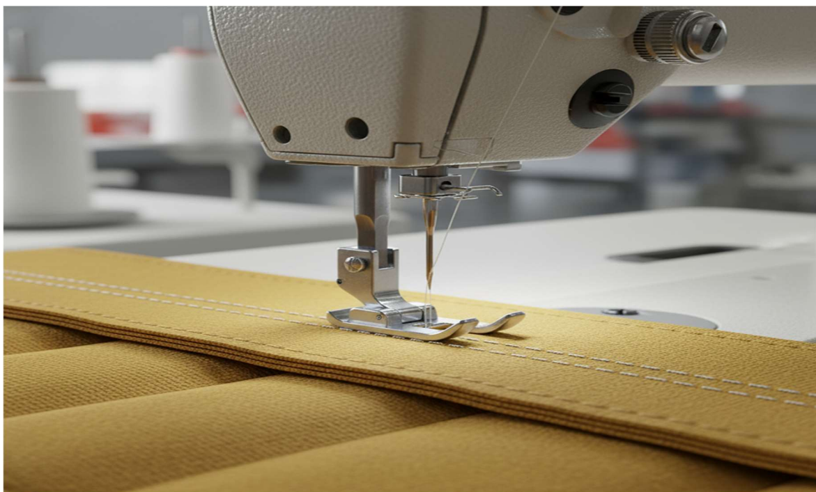
Figura 12 – Costura de múltiplas camadas de tecido em máquina industrial, simulando a confecção de uniformes de bombeiros em tecido de aramida. Risco de ruptura de linha durante costura
