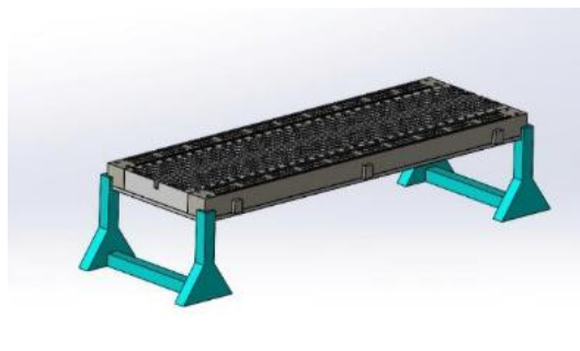
Figura 9: Representação 3D da protoboard no suporte
