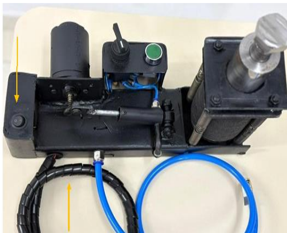
Figura 13: botões de acionamento, conexão para isqueiro automotivo e mangueira com bico.
