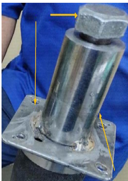
Figura 10: chapa, tarugo e parafuso de ajuste.
