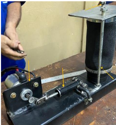
Figura 9: suporte do motor, suporte do cilindro, conector de eixo e hastes.
