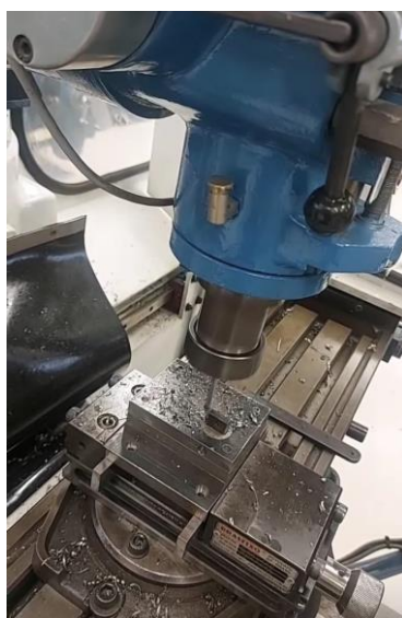
Figura 18: Placas matriz, placa guia, placa porta punção e placa porta espiga no processo de perfuração.
