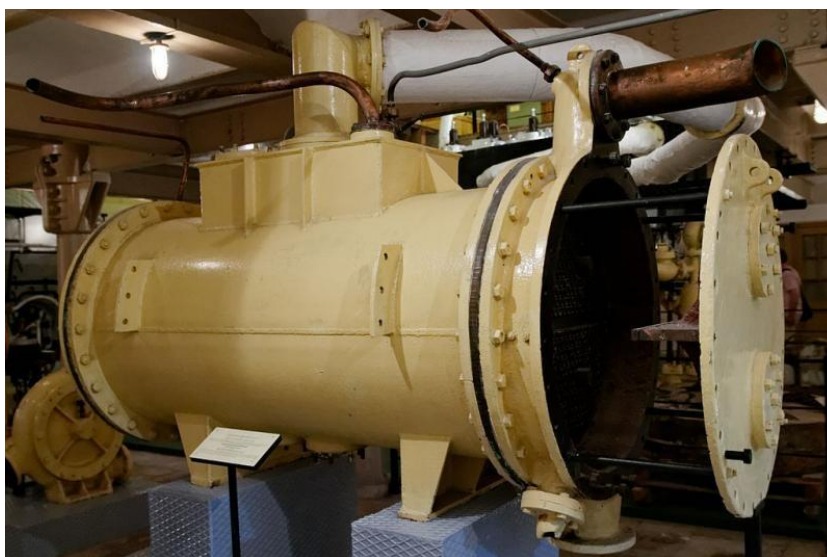
Figura 11 – Condensador para transformar vapor em líquido
