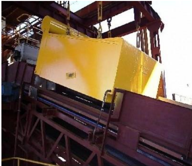
Figura 5 - Eletroímã para remoção de metais da cana
