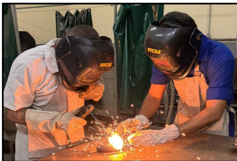
Figura 8 – Solda dos perfis metálicos.
