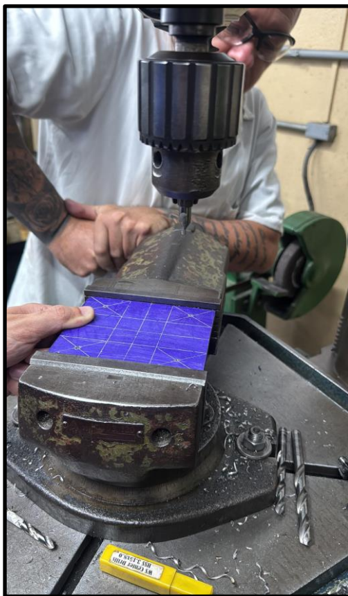
Figura 9 – Traçagem e furação da base dos montantes do corrimão.
