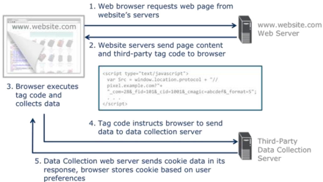
Figura 7 - Funcionamento de um Pixel
