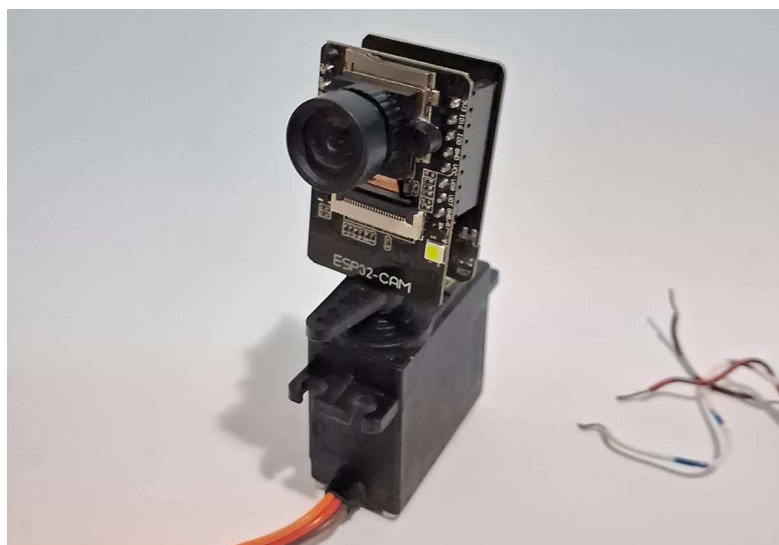
Figura 32 - Circuito ESP32-CAM sobreposto ao circuito receptor
