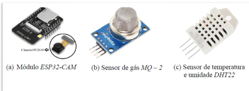
Figura 10 - Proposta de sistema de monitoramento de incêndios ambientais utilizando o ESP32-CAM
