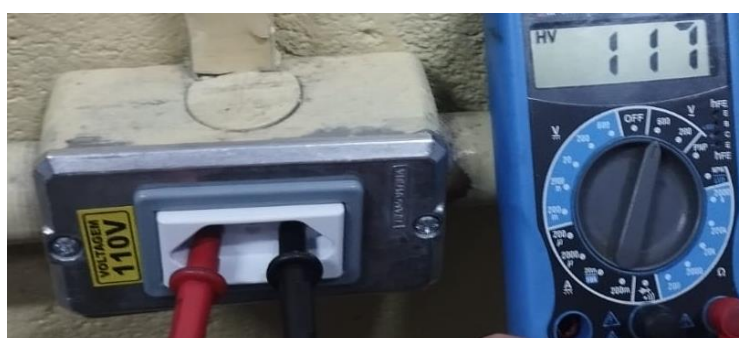
Figura: 37 - Medição da tensão elétrica em circuito TUG 127 V
