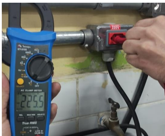
Figura: 39 - Medição da tensão elétrica em circuito TUE 220 V
