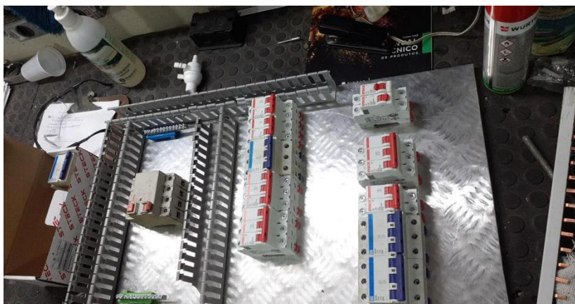
Figura: 28 - Procedimento de montagem do painel elétrico em bancada
