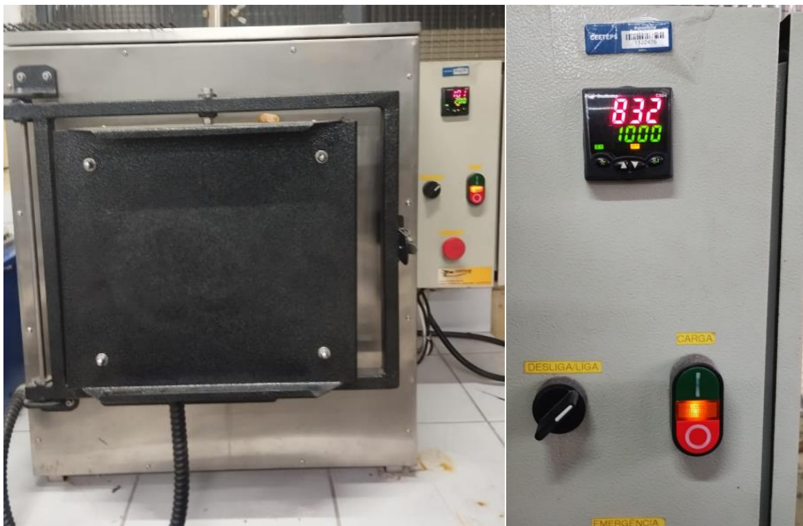
Figura: 42 - Forno elétrico do laboratório em funcionamento para testes, com temperatura de setpoint 1000°C e atingindo 832°C no momento do registro.
