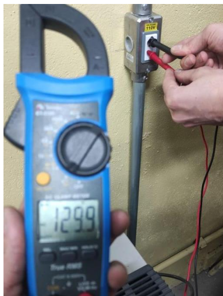
Figura: 38 - Medição da tensão elétrica em circuito TUE 127 V
