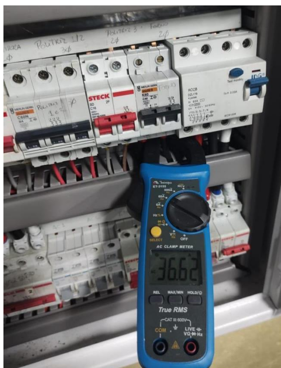
Figura: 43 - Medição da corrente elétrica do circuito de alimentação do forno elétrico, durante o seu pleno funcionamento.
