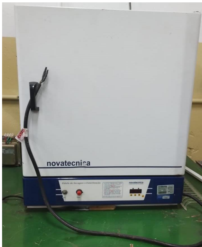
Figura: 15 - Estufa de esterilização: sem o conector elétrico e sem ponto de tomada para utilização
