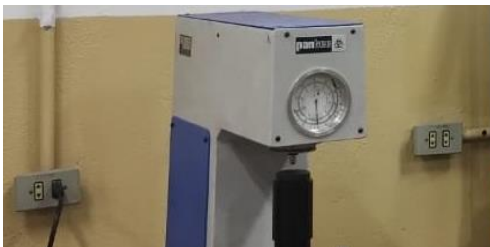
Figura: 16 - Tomadas de uso geral fora do padrão da atual e sem pino de aterramento.
