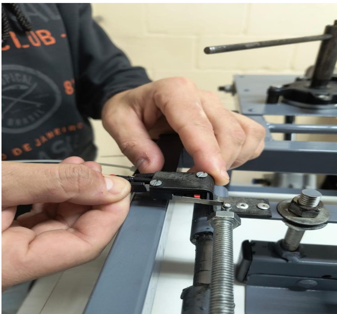
Figura 26 – Chave micro swift – Sinal para interromper o funcionamento do motor.
