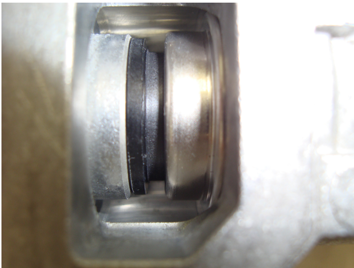
Figura 33. Teste em outro modelo de IACV, sem sinal de acionamento.
