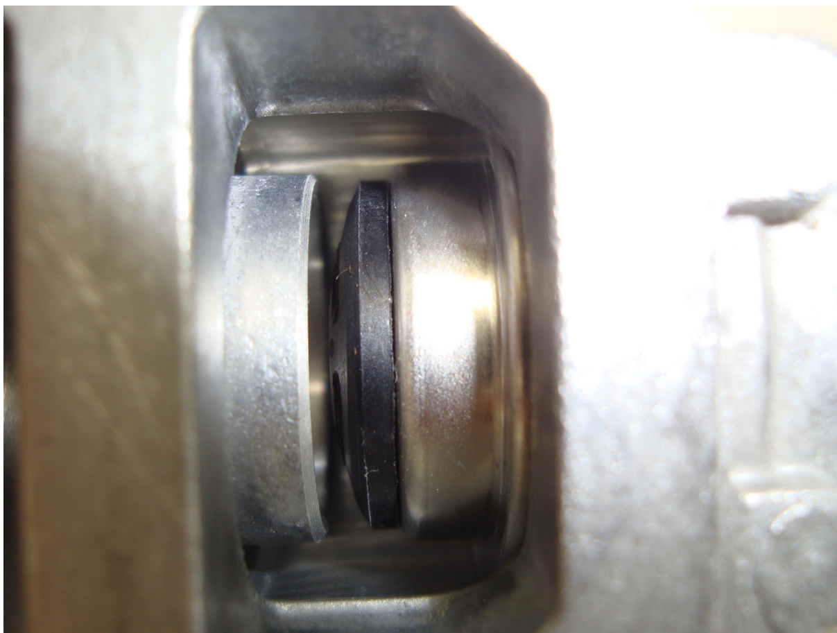
Figura 34. Teste em outro modelo de IACV, com sinal de acionamento.
