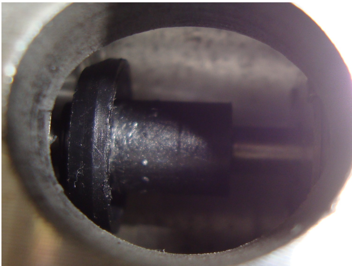
Figura 35. Teste no modelo de IACV estudado, sem sinal de acionamento.
