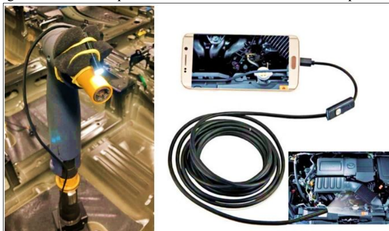
Figura 14 - MVP Dispositivo de Visão com Câmera Endoscópica
