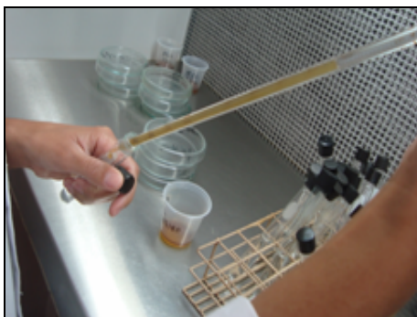
FIGURA 12 – Diluição da amostra de mosto da Usina Santa Adélia. FONTE: Acervo próprio
