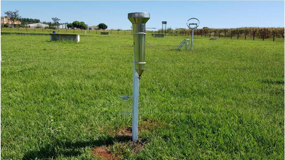
Fotografia 3 - Pluviometro Ville de Paris da Estação Agroclimatológica da UNESP de Jaboticabal
