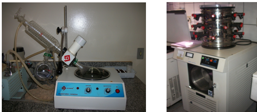
Figura 6 – Rotaevaporador e liofilizador utilizado
