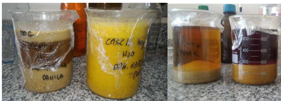
Figura 4 – Maceração da semente e casca em água e etanol 70%.
