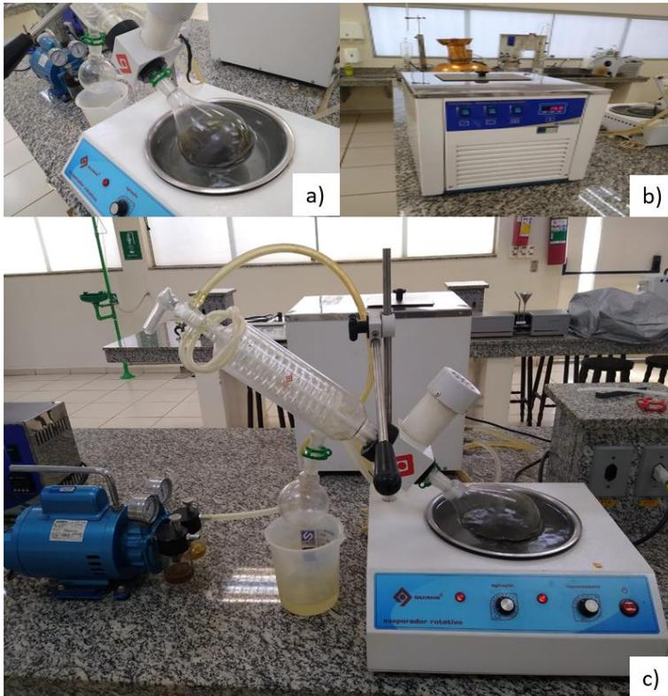
Processo de rota-evaporação (a) Trocador de calor (b) Sistema completo com compressor de ar (c) (Fonte: Alexander S. K. Moura)
