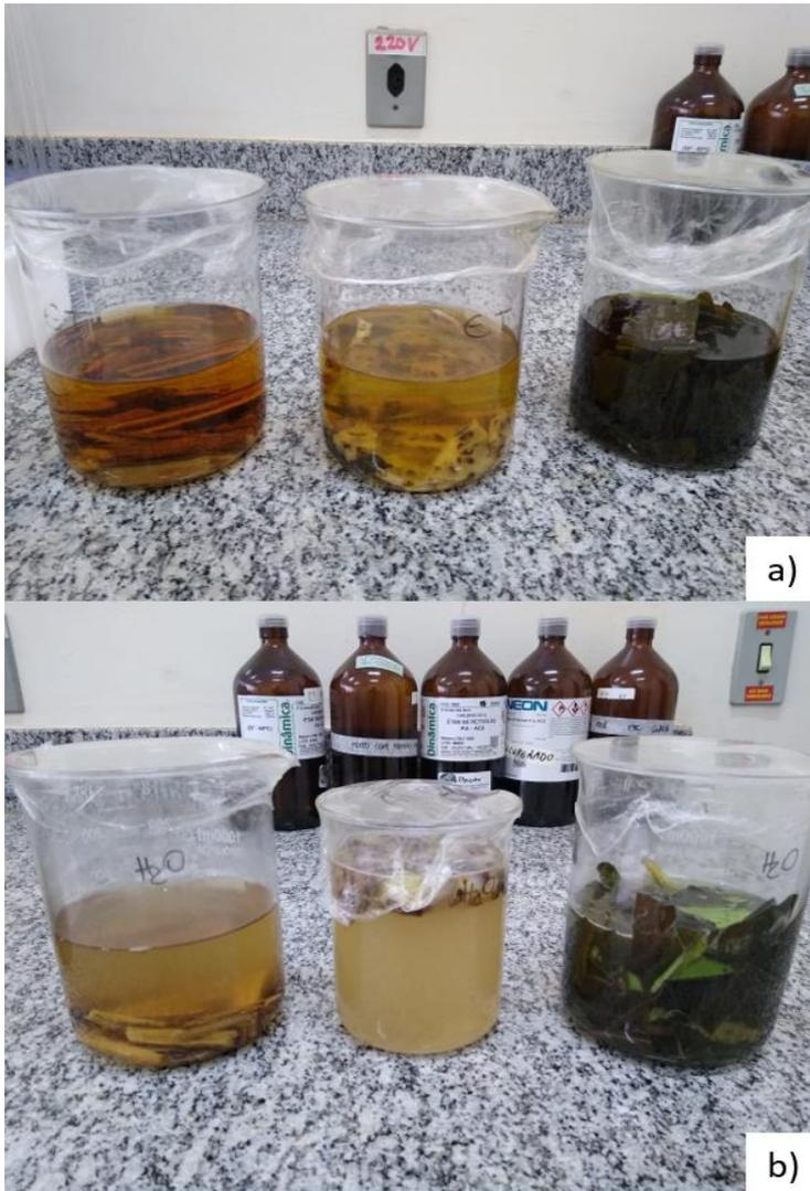
Após 7 dia em maceração alcoólica (a). Após 3 dia em maceração Aquosa (b). (Fonte: Alexander S. K. Moura)
