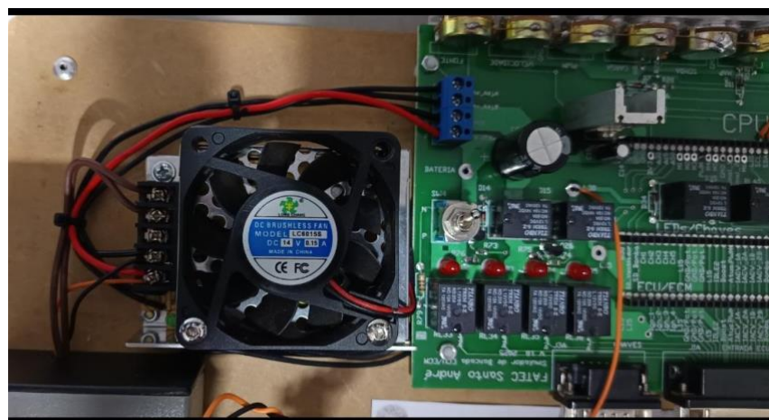
Figura 49- Teste do Sinal do Relê do Eletroventilador
