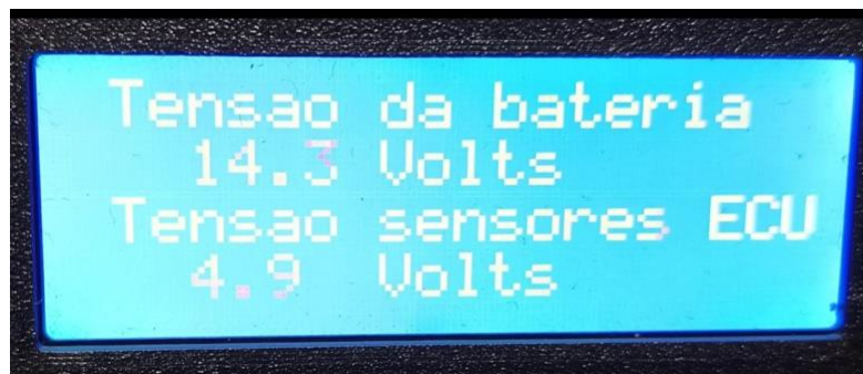
Figura 53 – Teste de Alimentação da Tensão dos Sensores e da ECU
