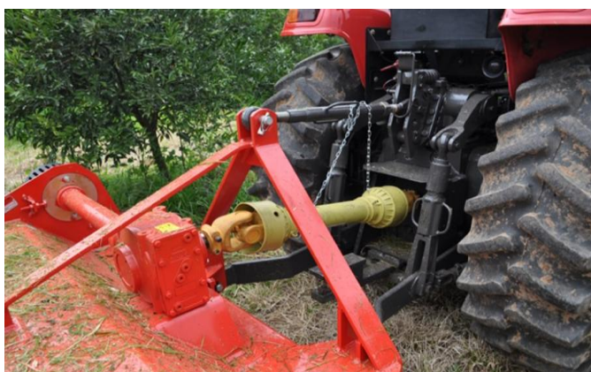
Figura 77 -- Implemento acoplado na TDP e sistema de três pontos
