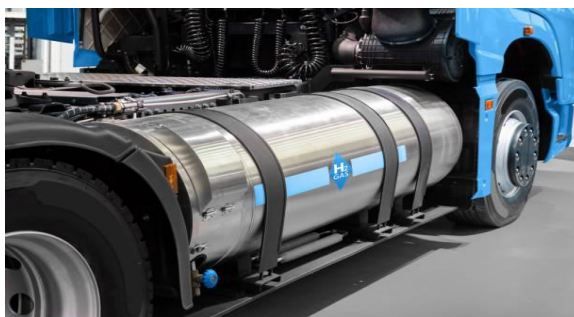
Figura 69 – Tanque de armazenamento do hidrogênio gasoso em um caminhão
