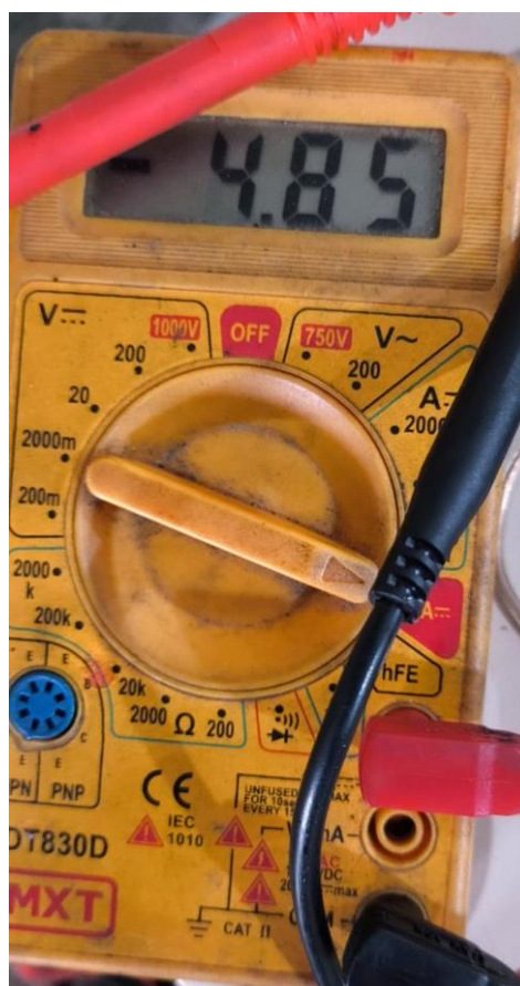
Figura 30 - Corrente Solenoide de Trava Elétrica
