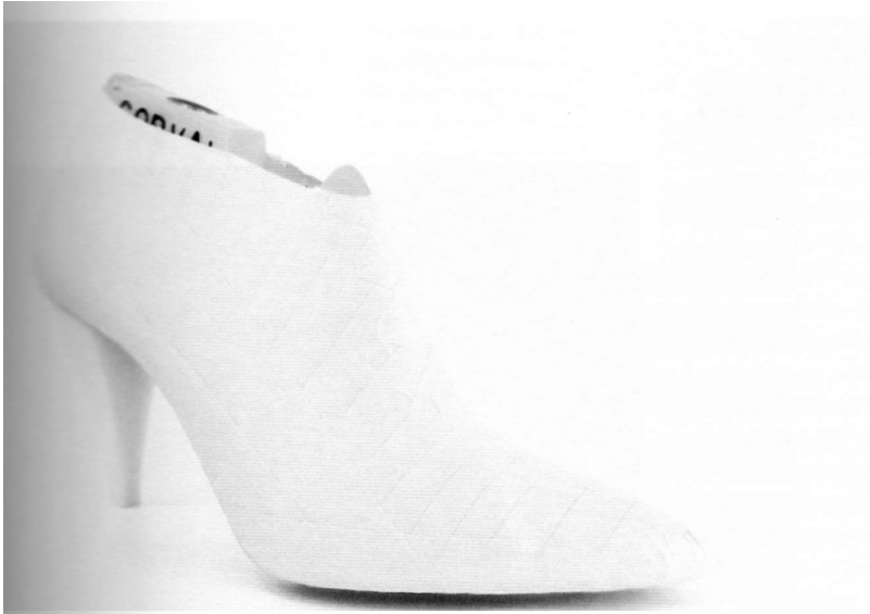
Imagem 20. Fôrma adesivada, desenho, e molde planificado
