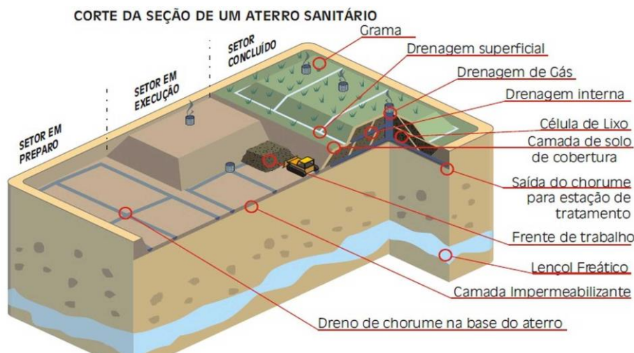
Figura 3 – Esquema de um aterro sanitário
