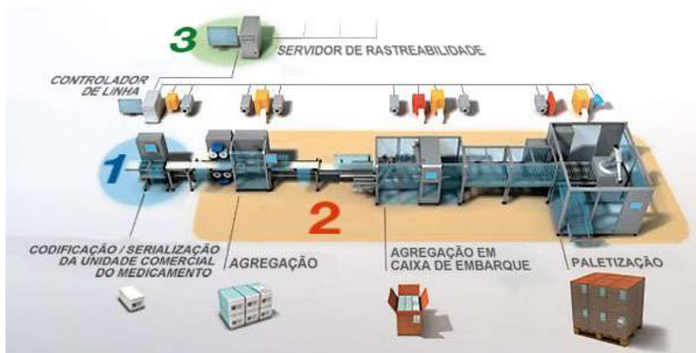
Figura 6 – Processo de serialização e agregação
