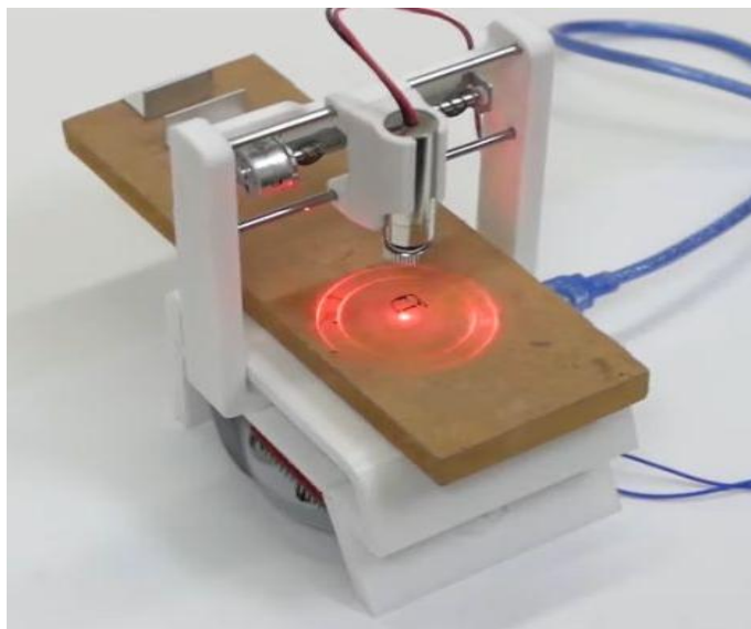
Figura 13 – Mini gravadora a laser em funcionamento (gravação ativa)
