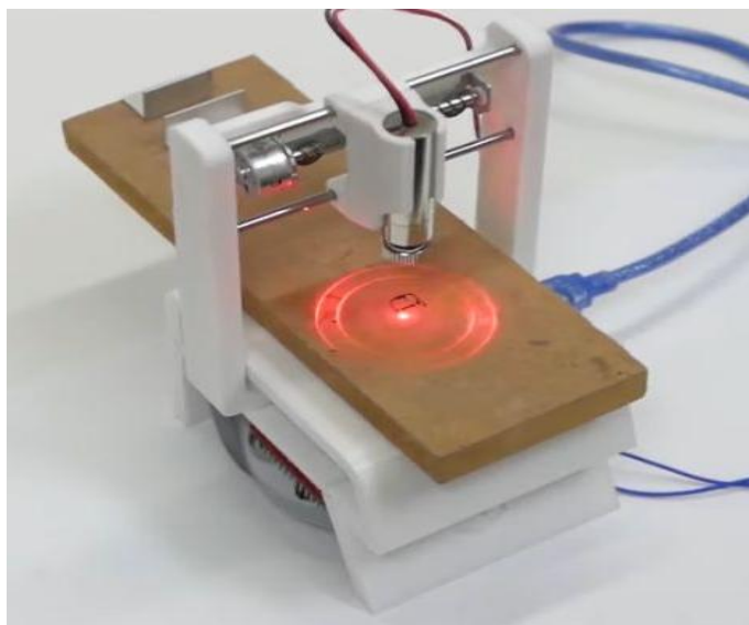
Figura 17 – Sistema CNC em operação com controle via software Benbox.
