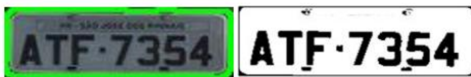
Figura 7 - Resultado do reconhecimento de caracteres com OpenCV e Tesseract
