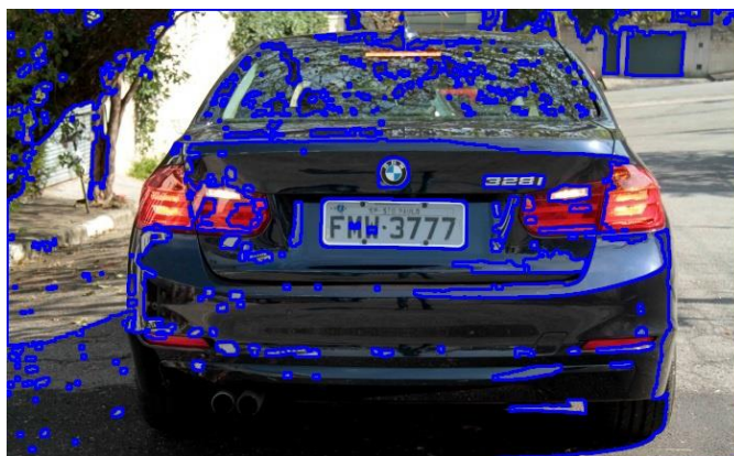
Figura 32 – Contornos encontrados na etapa de identificação da placa
