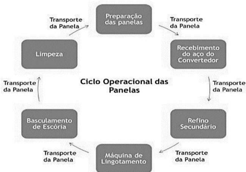
Figura 4 – Ciclo operacional em um forno siderúrgico
