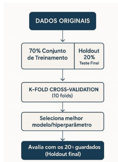
Figura 2 - Representação esquemática do processo de validação cruzada k-fold e validação Hold-out .
