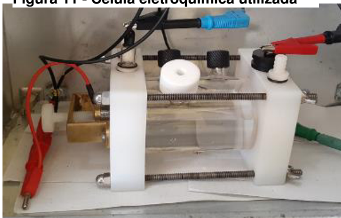
Figura 11 - Célula eletroquímica utilizada
