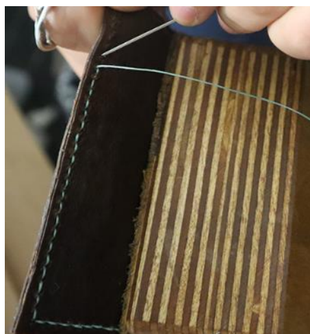
Figura 5: Fabricação de artefatos com o “couro de laboratório”
